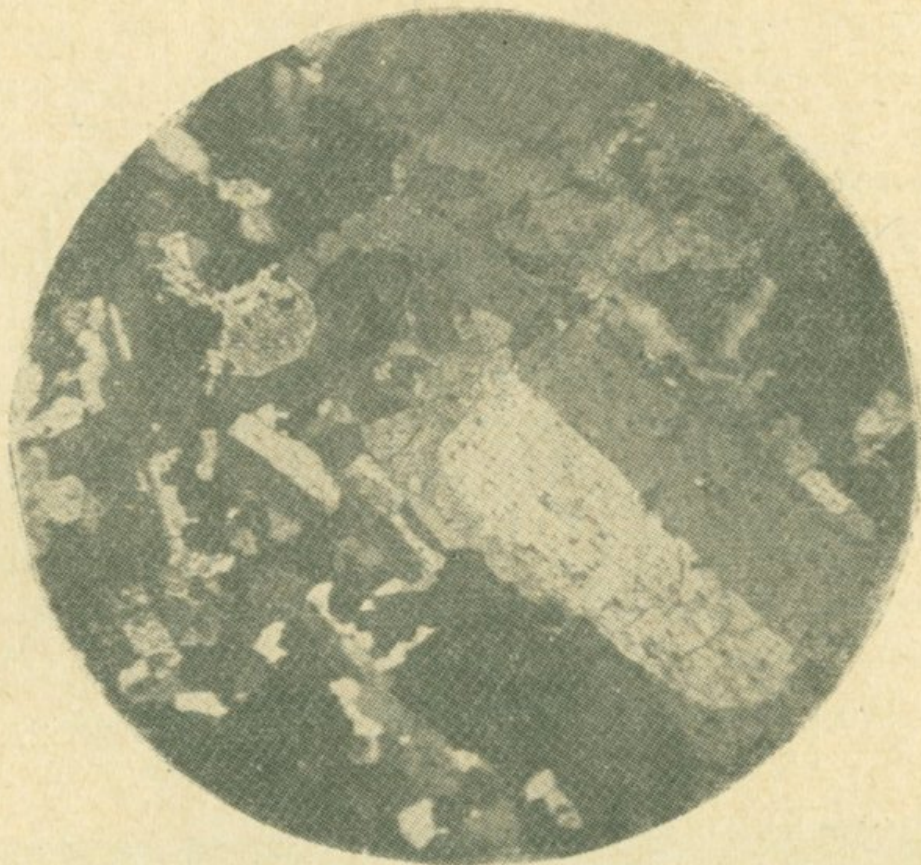
Рис. 27. Граносиенит. Скрещ. ник., ув. 64.
