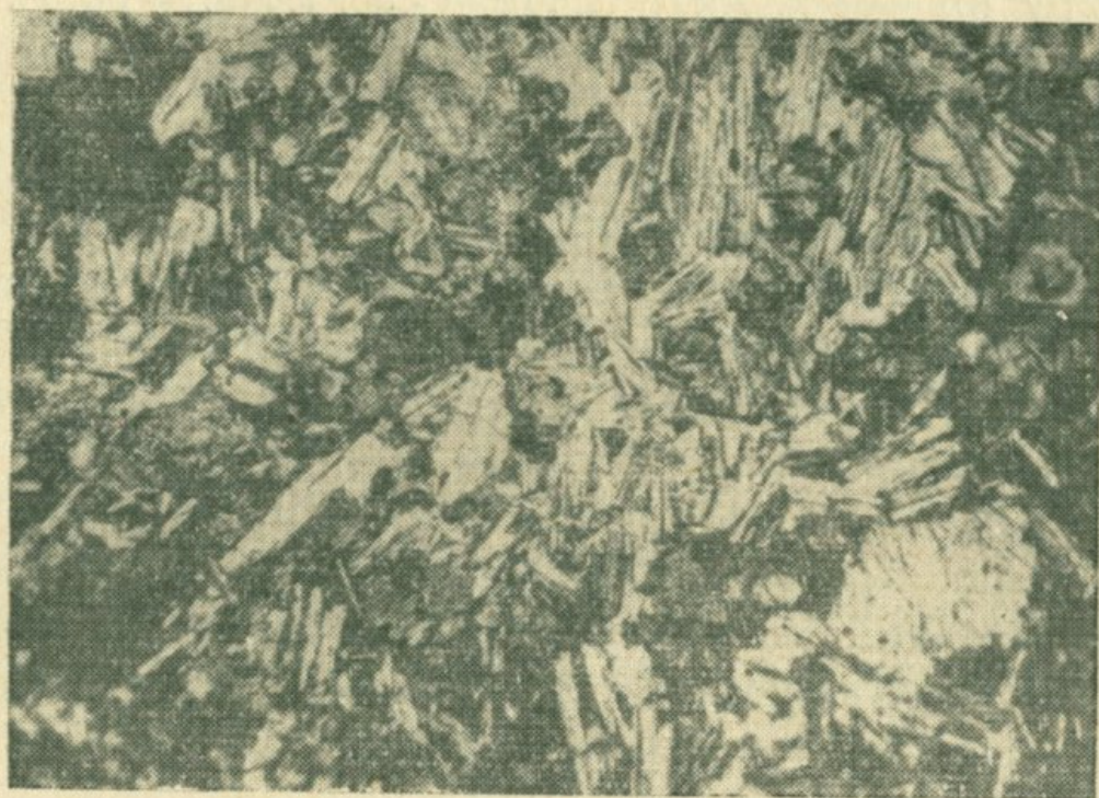
Рис. 7. Оливино-биотито-ортоклазовое габбро. Скращ. ник., ув. 50.
