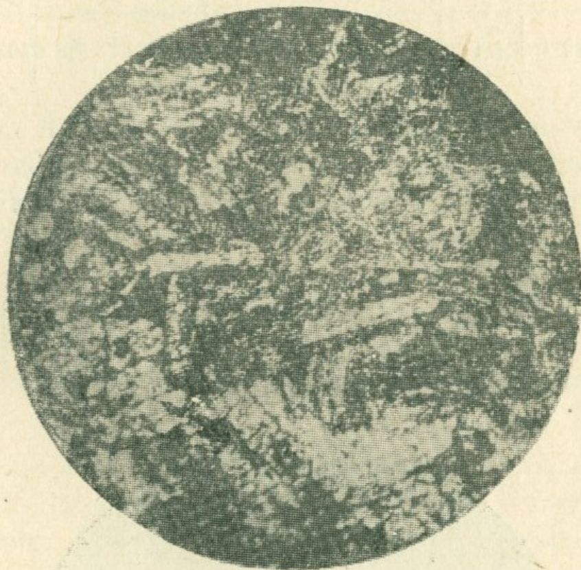
Рис. 9. Анортозит. Скрещ. ник., ув. 64.
