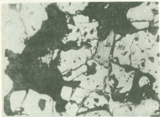
Рис.23.Чешуйки молибденита Мо в интерстициях зерен пирита. Агаракское месторождение.Политованный шлиф.Ув.120.
