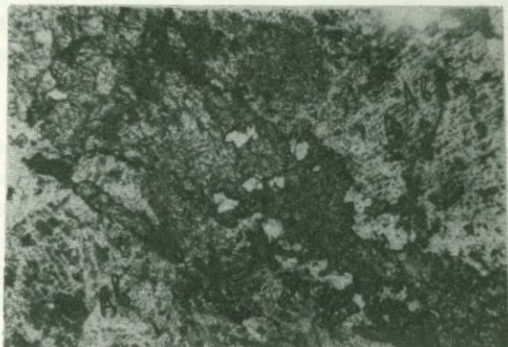
Рис.133. Образование альбита (Ab) вдоль эпидотового прожилка. Каджаранское месторождение. Прозрачный шлиф. Ув.24.
