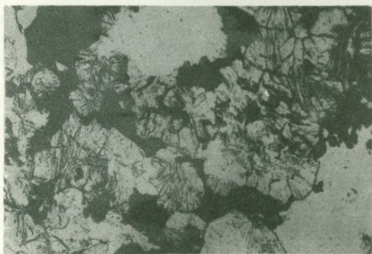
Рис.129.Веерообразные агрегаты хлорита (репидолит) разъедаются и цементируются рудным минералом. Дастакертское месторождение.Прозрачный шлиф. Ув.90 без анализатора.По М.П.Исаенко.
