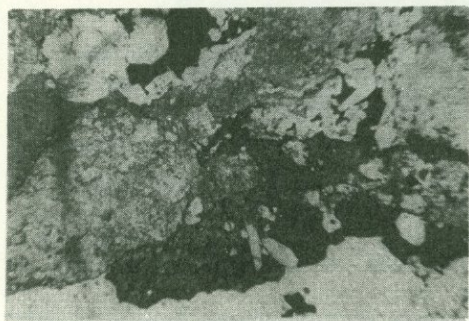
Рис.131.Образование микрожеод замещения кварца в гранодиорит-порфирах Джиндаринского месторождения.Прозрачный шлиф.Ув.60.
