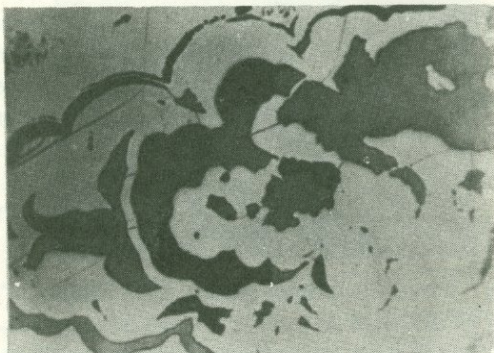
Рис.120.Чередование колломорфных выделений гётита (светло-серое) и малахита (темно-серое).Каджаранское месторождение.Полированный шлиф. Ув.60.
