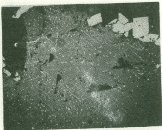
Рис. 46. Эмульсионно-ориентированная структура распада сфалерит-халькопирит. Тейское месторождение. Полированный шлиф. Ув. 90.
