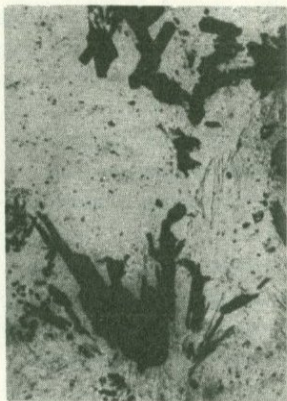
Рис. I4I. Выделение призматических кристаллов рутила при серицитизации гранодиоритов. Дастакертское месторождение. Прозрачный шлиф. Без анализатора. Ув. 24.
