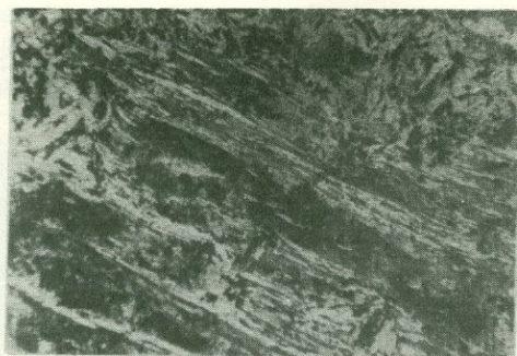
Рис.130. Хлоритизированная роговая обманка. Видно выделение рудного минерала (черное). Джиндаринское месторождение. Прозрачный шлиф. Ув.90. Без анализатора.
