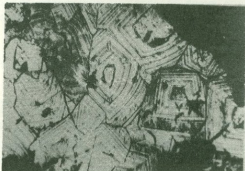
Рис.126.Зональная структура повеллита кристаллизованная в пустотах.Каджаранское месторождение.Ув.165. По М.П. Исаенко.
