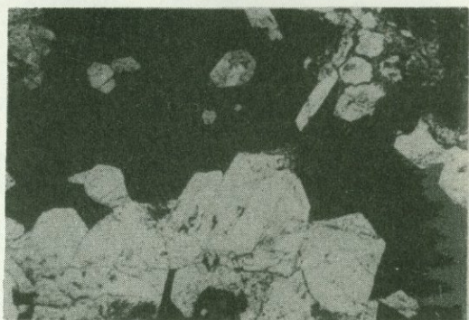
Рис. 104. Кристаллы апатита (белое), сцементированы магнетитом (черное). Камакарское месторождение. Прозрачный шлиф. Ув. 80. По Г. Б. Междумян.
