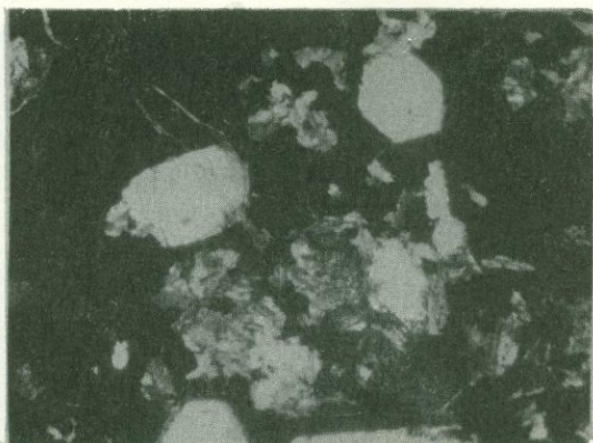
Рис. I05. Кристаллы апатита и чешуйки биотита раннего этапа минералообразования сцементированы массивным халькопиритом позднего этапа минералообразования. Каджаранское месторождение. Прозрачный шлиф. Ув. 90.
