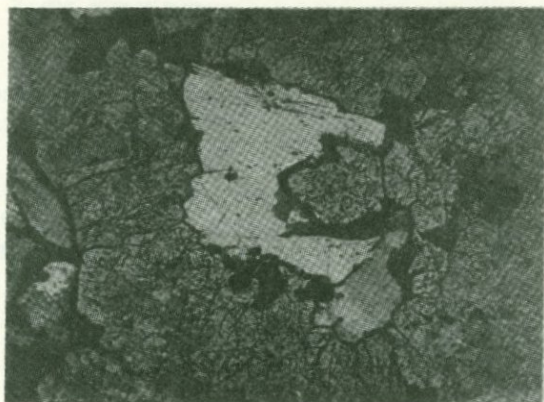
Рис.18. Пластинчатое выделение молибденита в магнетите. Молибденит заполняет промежутки зерен магнетита. Полированный шлиф. Ув.90.
