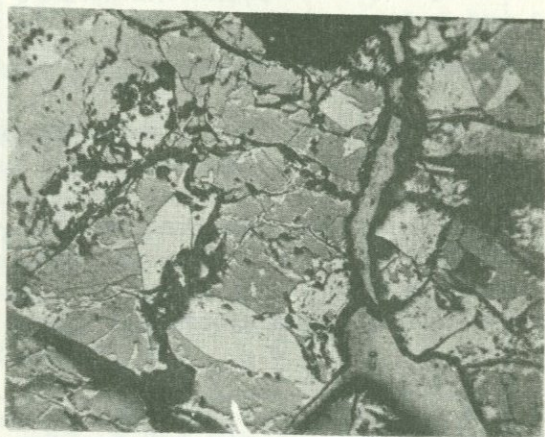
Рис.73. Мартитизация магнетита. Каджаранское месторождение. Полированный шлиф. Ув.120.
