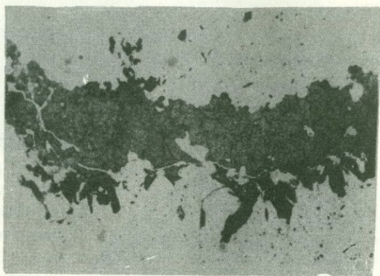
Рис.80.Выделение шеелита (рельефное) в кварц-молибденитовом прожилке.Молибденит (черное) приспособливается к выделениям шеелита.Каджаранское месторождение.Прозрачный шлиф.Ув.150.
