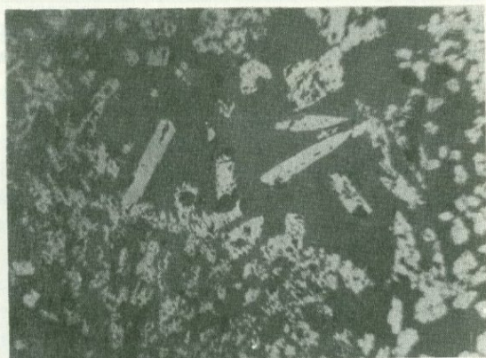
Рис.75.Призматические кристаллы гематита в кварце и кварц-молибденит-халькопиритовой ассоциации.Дастакертское месторождение.Полированный шлиф.Ув.90.
