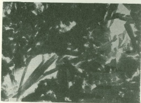
Рис.123.Микроморфология кристаллов галлуазита.Ув.15000.
