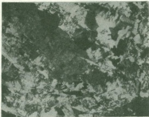
Рис.102.Проникновение ангидрита в барит. Прозрачный шлиф.Ув.90.Каджаранское месторождение.
