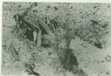
Рис.136.Чешуйчатые и сноповидные агрегаты серицита в грейзенах с.Аравус. Промежутки заполнены рудным минералом (Ср).Прозрачный шлиф.Ув.60.Месторождение Аравус.
