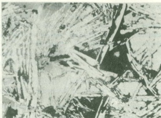
Рис.74.Пластинчатые кристаллы гематита. Кварц-гематитовые прожилки.Бугаракское месторождение.Полированный шлиф.Ув.100.
