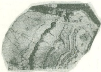
Фиг. 7. Проникновение раннего барита (темное) вдоль трещинок усыхания и концентрических зон почковидного пирита. Полир.штуф. Нат.вел.
