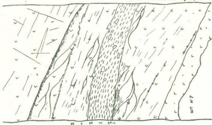
Фиг. 23. Деталь участка на фиг. 59. 1 - габбро-диабазовая дайка; 2 - карбонат с гнездышками халькопирита; 3 - вкрапленность халькопирита; 4 - мелкая трещиноватость.
