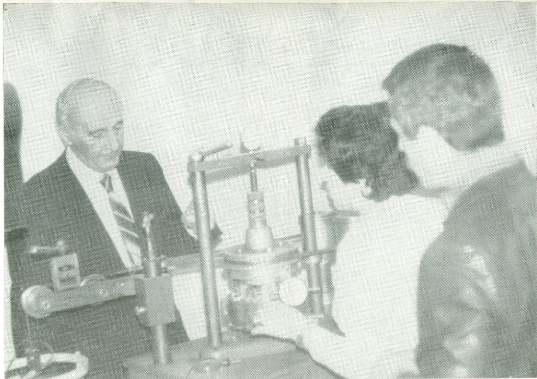
Руководитель лаборатории геомеханики чл.-кор. АН АрмССР Г. И. Тер-Степанян с научными сотрудниками проводят эксперимент по испытанию грунта на сдвиг на кольцевом приборе.
