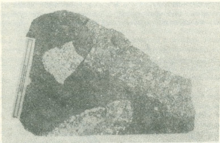
Рис. 2. Пиритизированные обломки пород в взрывной брекчии. Отчетливо наблюдается более интенсивная пиритизация по периферии двух крупных обломков. Редкая вкрапленность пирита отмечается и в цементе брекчий. Полированный штуч.
