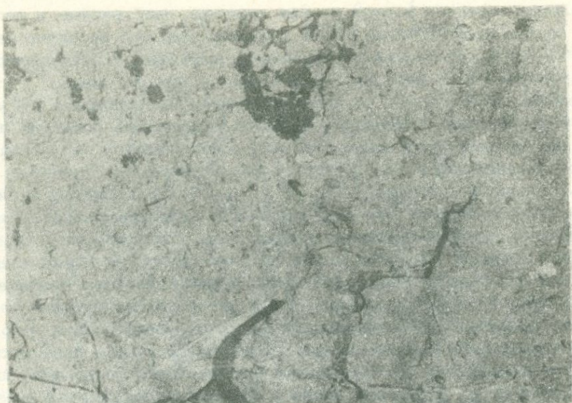
Рис. 4. Миндалины и прожилки (внизу) цеолита в ассоциации с хлоритом в породах титона-валанжина (Гедаклу).
