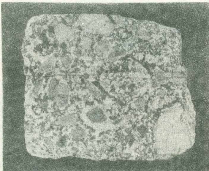
Рис. 4. Брекчиевидная текстура магнетит-апатитовой руды. Обломки андезито-дацитов (серое) сцементированы измененной нерудной массой с вкрапленностью магнетита (темно-серое) и апатита (светло-серое). Полиров. штупф, 2/3 нат. вел.
