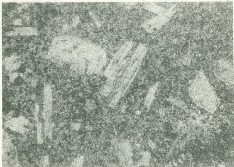
Рис. 5. Рудовмещающий андезит-дацит. Порфировые выделения плагиоклаза (светло-серое) среди гипокристаллической основной массы. Прозрач. шлиф, ув. 70\times .
