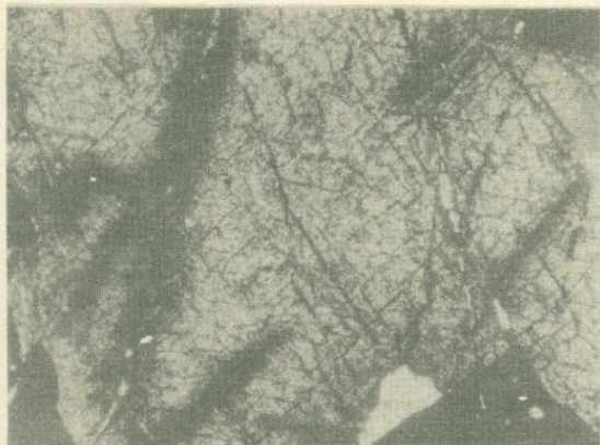
Рис.8. Изменение окраски медово-желтого сфалерита (светло-серое) на контакте с пиритом (черное). Прозрачно-полированный шлиф. Ник. П, Ув. 70
