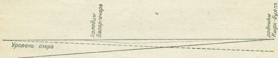
Фиг. 14. Взаимоотношение поверхностей дневной и водоупорной, и поверхность грунтовой воды (пунктир) в Мазринской долине.
