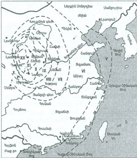
Սկ. 1.42 Զինաստանի 1920 թվականի երկրաշարժի իզոսեյստերը [12] ուժգնությունը ցույց է տրված հռոմեական տառերով, սլաքներով նշված են առաջինը զգացող շարժումների ուղղությունները:
