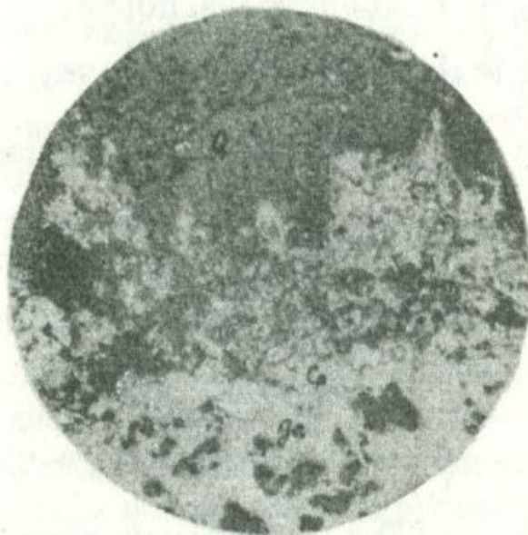
Фиг. 49 д . Взаимоотношения халь- копирита с галенитом: выделения халькопирита (Cp) цементируются галенитом (Ga), серое-кварц (q). М-ние Тандзут, ув. 35х.
