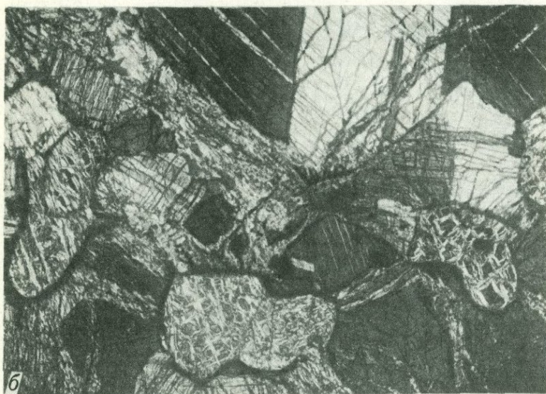
Рис. 50. Кристаллобластическая структура лейкократового троктолита, форма реликтов и микроклинцеватость субстрата с оливином в ячейках (шл. 248-68, увел. 20)
