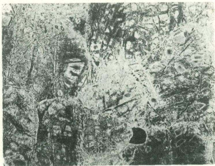
Рис. 10. Неравномерная перекристаллизация субстрата и степень сохранности его реликтов (шл. 244-67, увел. 40, без анализатора)
