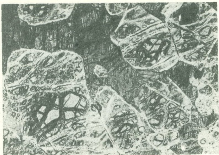
Рис. 40, Пойкилобласты диопсида, пересекающие полосчатость серпентинита (рис. 237-67, увел. 40, без анализатора)
