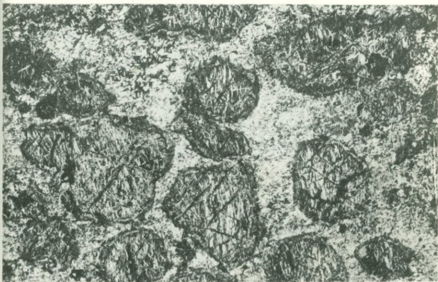
Рис. 13. Серпентинитовая брекчия – продукт многократной перекристаллизации дисперсного субстрата, сохранившего в реликтах полосчатое строение и дисперсное вещество в ячейках (шл. Ю-43-62, увел. 6, с анализатором)
