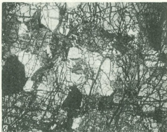
Рис. 32. Кристаллобластическая структура дунита и рисунок микровыделений магнетита, воспроизводящий петельчатую структуру субстрата (шл. 48-64, увел. 20)
