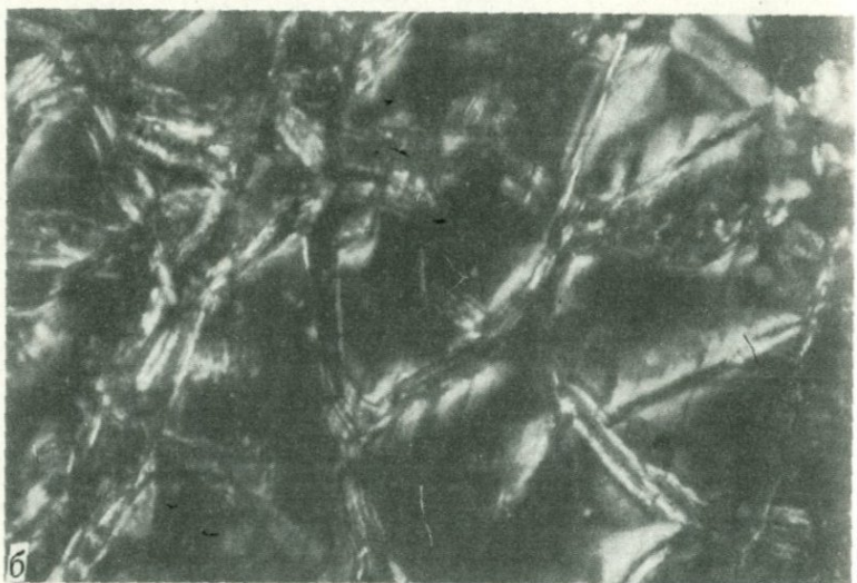
Рис. 16. Гомогенизация вещества ячеек и появление "спайности", пересекающей реликтовую петельчатую структуру субстрата (шл. 235-69, увел. 130)
