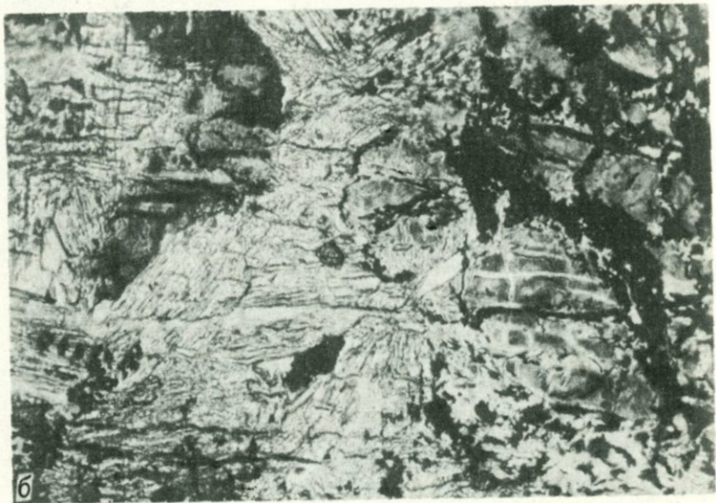
Рис. 53. Признаки метасоматического образования амфиболовых пород а - игольчатые каемки роста, разрастание в пойкилобласты и гомогенизация амфибола (шл. 47-68, увел. 130, без анализатора); б - присутствие реликтов субстрата и различный характер его преобразования (шл. 233-70, увел. 20, без анализатора)
