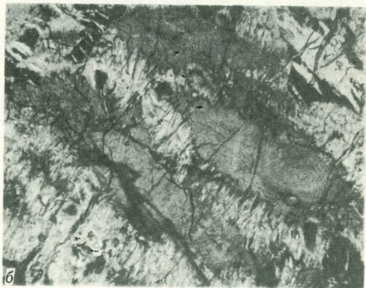
Рис. 6. Перекристаллизация субстрата в хризотиловый агрегат а - в виде прожилков (шл. 332-67, увел. 7, без анализатора), б - в виде участков (шл. 233-67, увел. 20, без анализатора)
