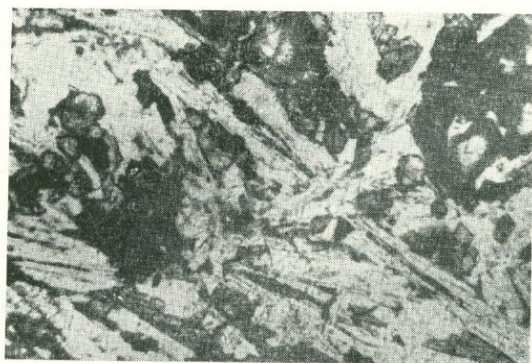
Фиг. 28. Верхний долерит с пойкилоофитовой структурой. Шл. 1054/33, с. Одзун. (ув. 63 ник. 11).
