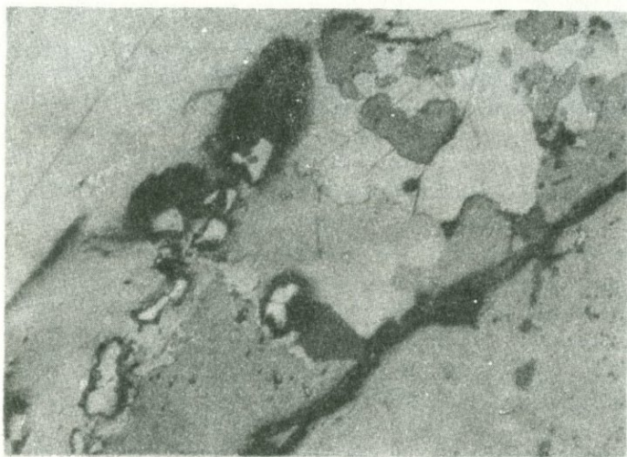
Рис. 48. Тесные сростания сфалерита (серое) с теннантитом (светло-серое) и галенитом (белое). Белое рельефное – пирит. Черное – пустоты. Полир. шлиф. \times 115 .
