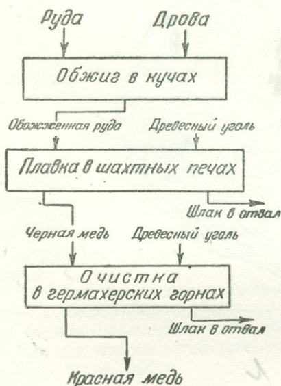
Рис. 6. Схема технологического процесса выплавки меди на Алавердском заводе в последней четверти XVIII в.
