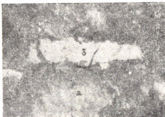
Фиг. 25а. Деталь поглощения рудной жилы (а) № 9 Халаджа дорудной диабазовой дайкой (б).
