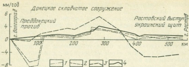
Рис. 6. Современные вертикальные движения по линии Волгоград—Ростов-на-Дону. Кривые — скорости вертикальных движений, вычисленных путем сравнения нивелирования разных лет. По В. А. Матцковой (1965 г.)
