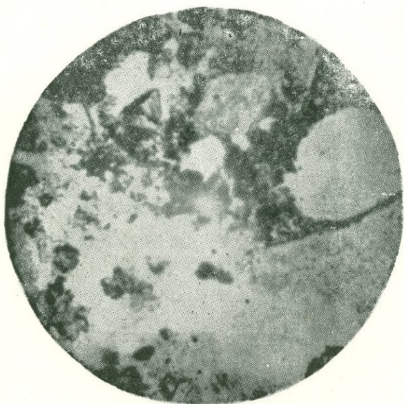
Фиг. 9. Одзунский храм. Микрофотография шлифа из наружной стороны облицовочного камня (проба № 4). Увелич. 200 \times . Ник.—. Черные участки представляют собой агрегат окисленного рудного минерала или окрашенные им участки породы.
