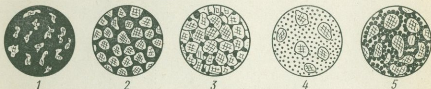
Рис. 30. Типы цементаций по М. С. Швецову (упрощенно):
