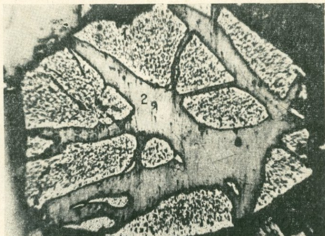
Рис. 2. Скелетная структура замещения зерна пирита (1) халькопиритом (2), черное—нерудный минерал. Полированный шлиф, \times 150 .
