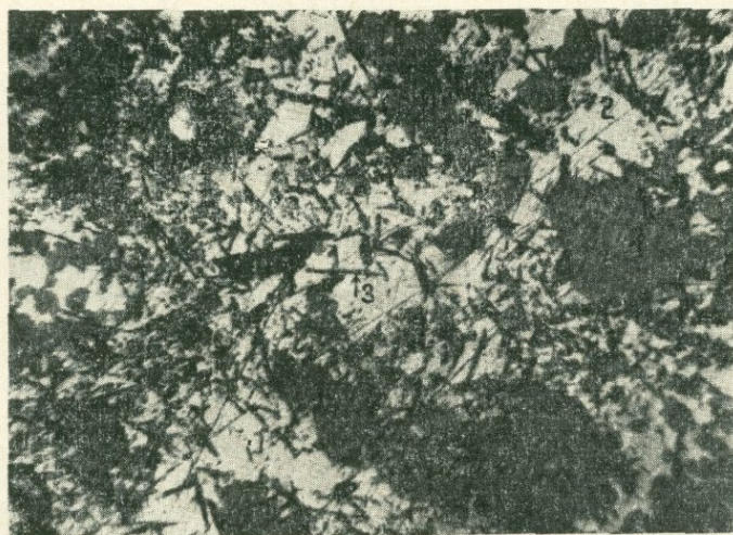
Рис. 9. Дробление и замещение сфалерита (1) галенитом (2). Выделения чешуек серицита (3) в полях галенита. Полированный шлиф, \times 100 .
