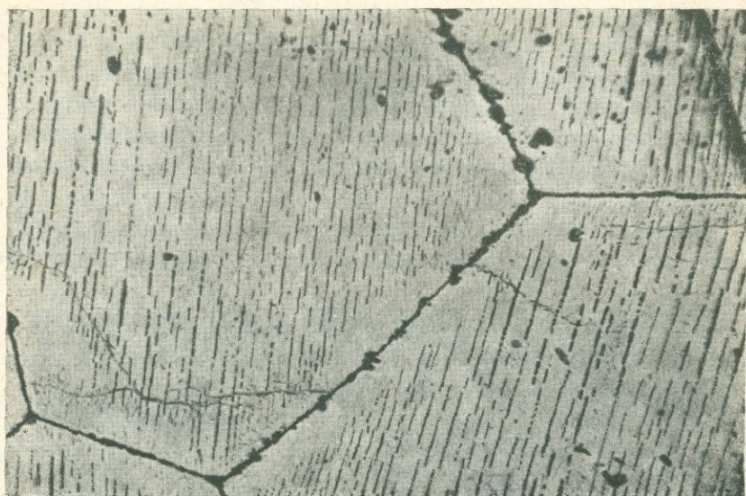
Фиг. 18. Панидиоморфнозернистая структура массивных титаномагнетитовых руд. Точечно-штриховидные выделения шпинели в зернах магнетита. Полиров. шлиф, ув. \times 90 .
