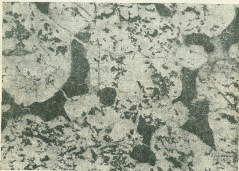
Фиг. 19. Пылевидные и точечные выделения вторичного магнетита среди серпентинов (псевдоморфозы вторичного магнетита по оливину). Магнетит—черный, серпентин—светло-серый. Прозр. шлиф, ув.×56.
