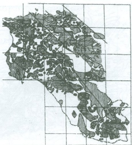
Рис. 3.2. Карта аномального поля вертикальной составляющей ( \Delta Z_a ), составленная Ц.Г. Акопяном. Сплошными линиями показаны основные направления простиранения аномалии геомагнитного поля. Прямой АБ показан профиль рисунка.
