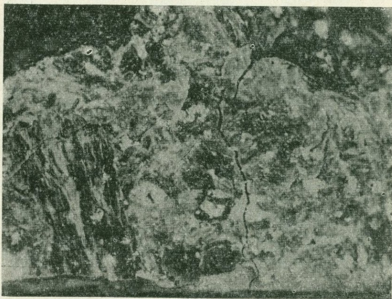
Рис. 8 а,б. Бентонитовые глины с сохранившимися реликтами смоляно-черных порфиринов и флюидалной текстуры. Уменьшены в 2 раза.
