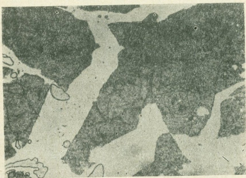
Рис. 9. а, б. Образование перлитовой текстуры в смоляно-черных порфиритах в процессе гидратации (бентонитизации). Ув. 45х.
