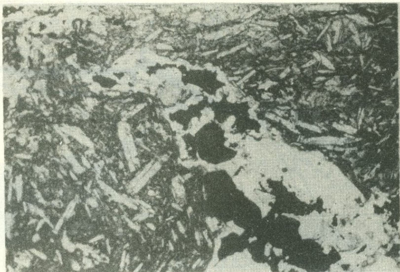
Рис. 34. Апофиза кварц-сульфидной жилы, проникающая в диабазовую дайку. Прозрачный шлиф. Увел. 17 х, б/а.
