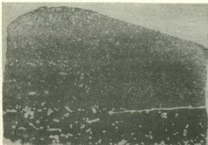
Рис. 62. Фото полированного штуфа. Вкрапленность пирита в пострудной дайке габбро-диорита (гор. 746 м). Уменьшено в 2 раза (Кафан).
