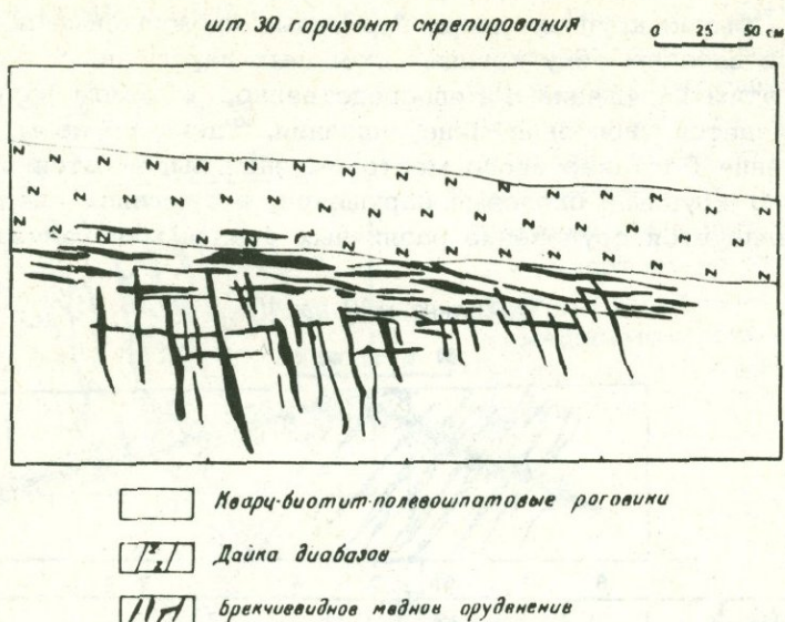
Рис. 17. Локализация богатого оруденения на контакте диабазовой дайки с роговиком.
