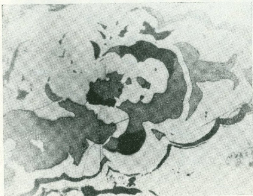
Рис. 55. Чередование колломорфных образований гетита (ht) и малахита (mal). Полир. шлиф, увел. 120. Месторождение Каджаран. По К. А. Карамяну.
