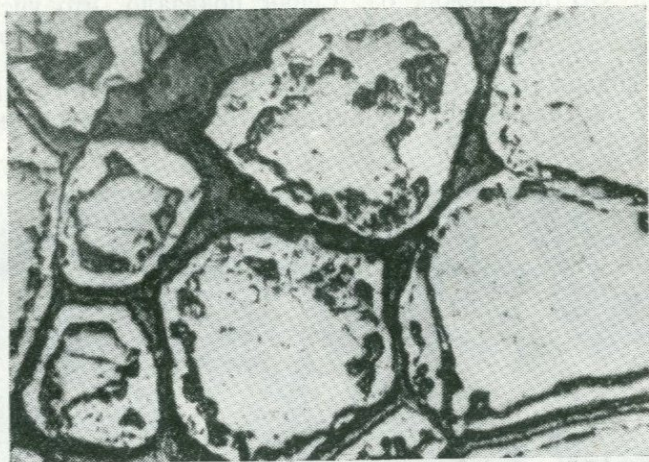
Рис. 30. Изометрические кристаллы хромита (Crt) окружены метаморфизованной магнитной каймой. Полир. шлиф, увел. 40. Месторождение Кочкаран. По С. Б. Абвяну.
