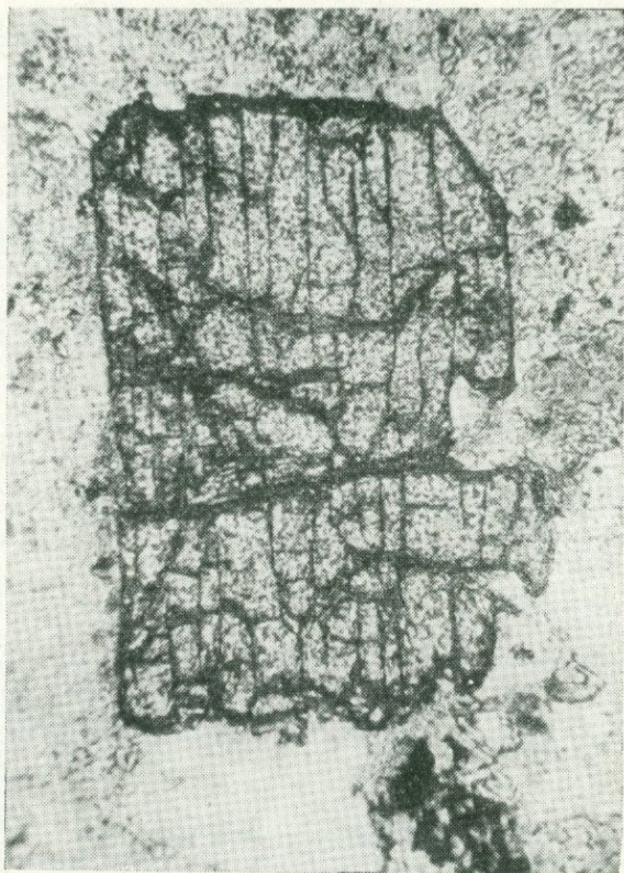
Рис. 64. Призматический кристалл монацита из гранит-порфиров (Мюльк-Джиндара). Увел. 32. Прозр. шлиф. По Б. М. Меликсетяну.
