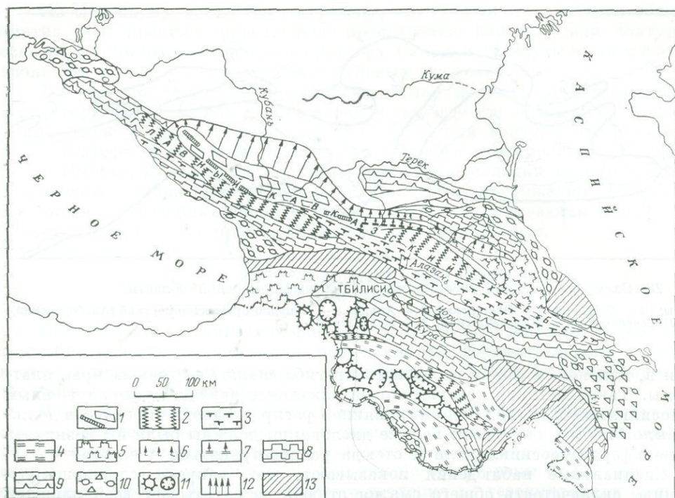
Рис. 29. Морфологические типы складчатости Кавказа (по А. А. Сорскому)
