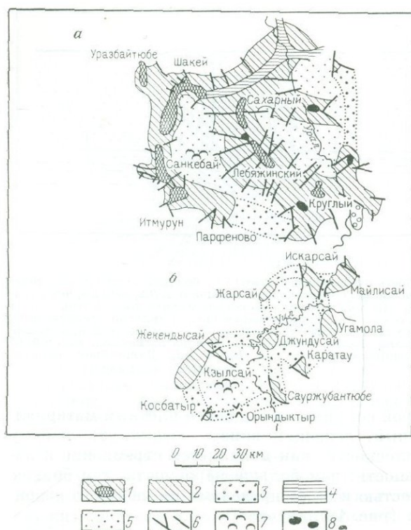
Рис. 19. Группирование диапировых куполов в неправильные кольца и многоугольники. Прикаспийская синеклиза (поверхность предверхнемиоценового среза)
