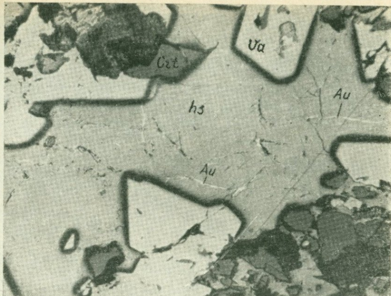
Рис. 50. Идиоморфные кристаллы ваэсита (va) цементируются гесситом (hs) с тонкими прожилками самородного золота (Au). Месторождение Зод. Аншлиф, \times 100 . По Ш. О. Амиряну.
