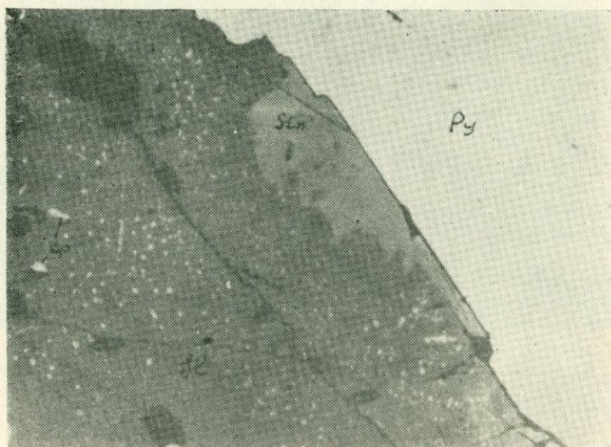
Рис. 88. Станнин (Stn) развивается в контакте с пиритом (Py), замещая сфалерит (Sl) с эмульсией халькопирита (Cr). Месторождение Зод. Аншлиф, \times 100 . По Ш. О. Амиряну.
