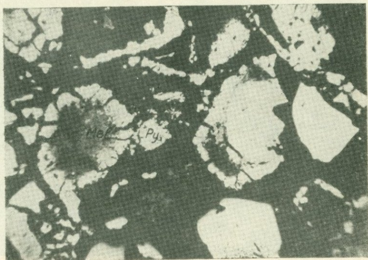
Рис. 46. Раскристаллизация мельниковита (Mel) с образованием пирита (Py) по краям его выделений. Месторождение Агарак. Аншлиф, х90. По К. А. Карамяну.
