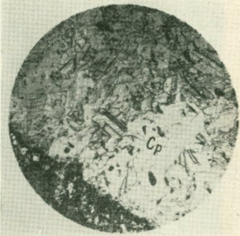
Рис. 84. Агрегат кристаллического халькопирита (протравлено конц. \text{HNO}_3 + \text{KClO}_3 ) с полисинтетическими двойниками в контакте с плохо отражающей смесью пирита + борнита + халькопирита. Месторождение Кафан. Анишлиф, х66. По И. Г. Магакьяну.
