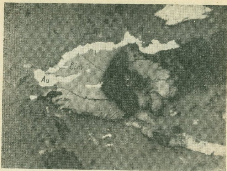
Рис. 7. Кайма самородного золота (Au) вокруг лимонита (lim) и по трещинке в нем. Месторождение Зод. Аншлиф, \times 100 , по Ш. О. Амиряну.
