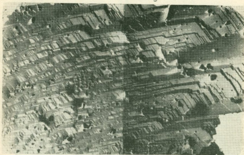
Рис. 31. Ступенчатое строение поверхности кристалла сфалерита. Месторождение Ахтала. Ув. 18000 (электронная микрофотография). По А. А. Коджояну и Св. С. Мкртчян.
