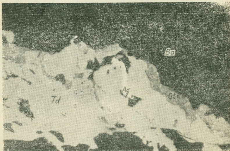
Рис. 3. Выделение самородного серебра (Ag) в трещинке блеклой руды (Td), которая по краям замещается штромейеритом (Str). Вмещающая масса—барит (Ba). Месторождение Ахтала. Аншлиф, х200, по В. О. Пароникяну.
