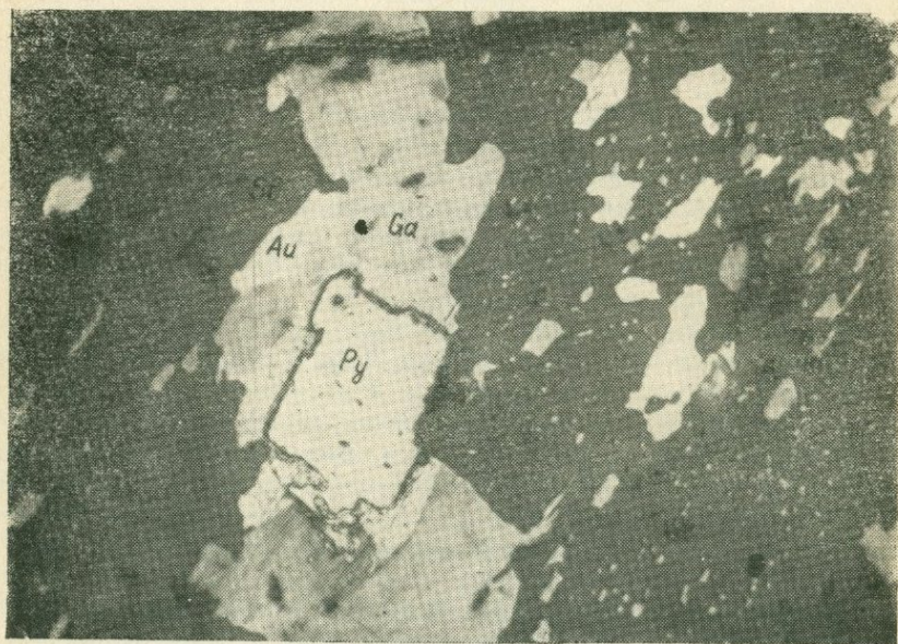
Рис. 5. Кристалл пирита (Py) окаймлен самородным золотом (Au); здесь же галенит (Ga) и сфалерит (Sl). Месторождение Тей, Аншлиф, \times 100 , по Ш. О. Амиряну.
