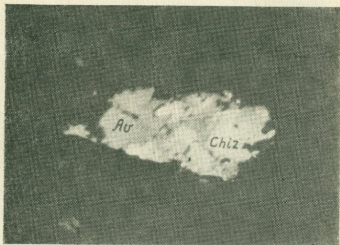
Рис. 18. Хизлевудит (Chiz) в сростании с аварунитом (Av). Месторождение Шоржа. Анишлиф, х40, по С. Б. Абовяну.
