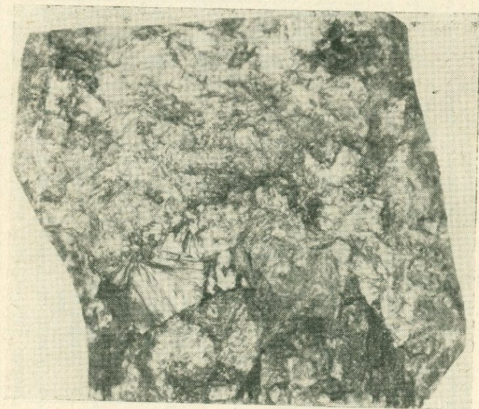
Рис. 62. Штриховка на гранях кристалла молибденита перпендикулярно его ребрам. Фото, натур. велич. Дастакертское месторождение. По К. А. Карамян.
