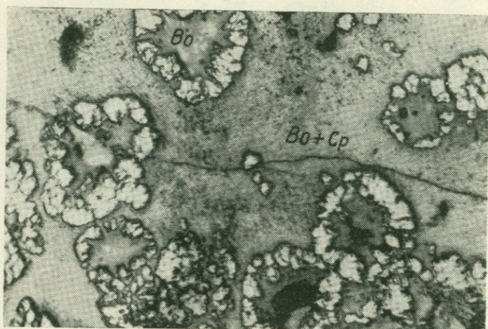
Рис. 45. Сферические стяжения пирита с полостями, выполненными борнитом (Bo) в борнит-халькопиритовой (Bo—Cr) массе. Месторождение Дастакерт. Аншлиф, \times 200 . По Г. О. Пиджяну.
