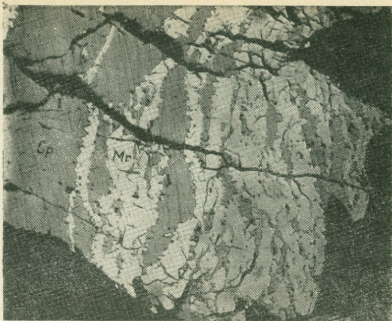
Рис. 64. Халькопирит (Cp) замещается марказитом (Mg). Месторождение Тей. Аншлиф, х42. По Ш. О. Амиряну.
