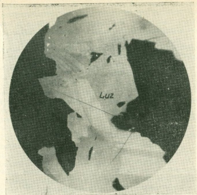
Рис. 92. Двойниковое строение кристаллического агрегата люцитона. Месторождение Каджаран. Аншлиф, \times 280 . По А. С. Фарамазю.
