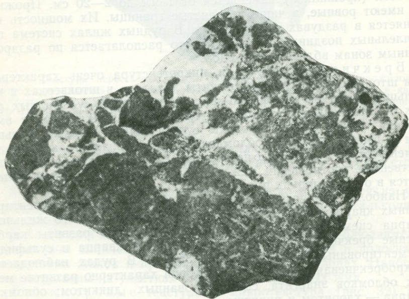
Рис. 35. Брекчиевая и прожилковая текстуры. Обломки породы (черное, серое) сцементированы кальцитом (белое). Месторождение Кафан, Армянская ССР. Обр. 186
