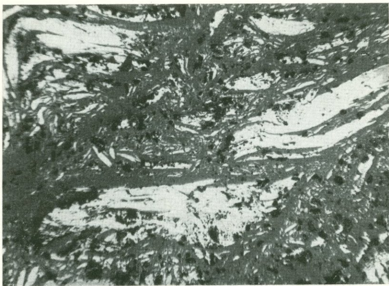
Рис. 137. Структура расщепления и смятия (в левом верхнем углу) в агрегате молибденита (белое); кварц (темно-серое). Месторождение Каджаран, Армянская ССР. Полированный шлиф. Ув. 90
