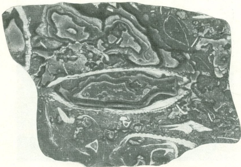
Рис. 46. Унаследованная органогенная текстура. В массе гидрогётита (черное, темно-серое) видны остатки створок раковин (белое). Керченское месторождение, Железная Балка. Образец
