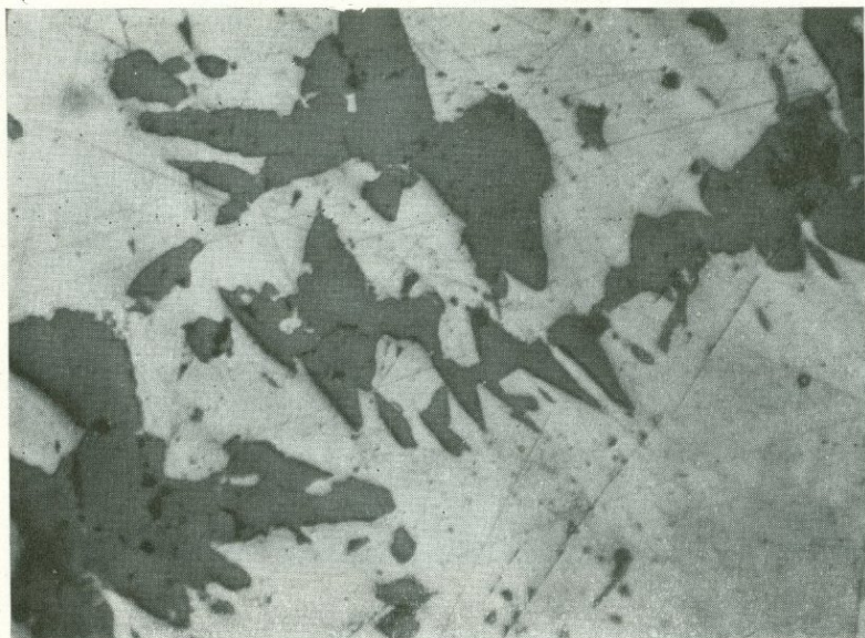
Рис. 99. Реликтовая структура. Реликты сфалерита (серое) в галените (белое). Полированный шлиф. Ув. 40
