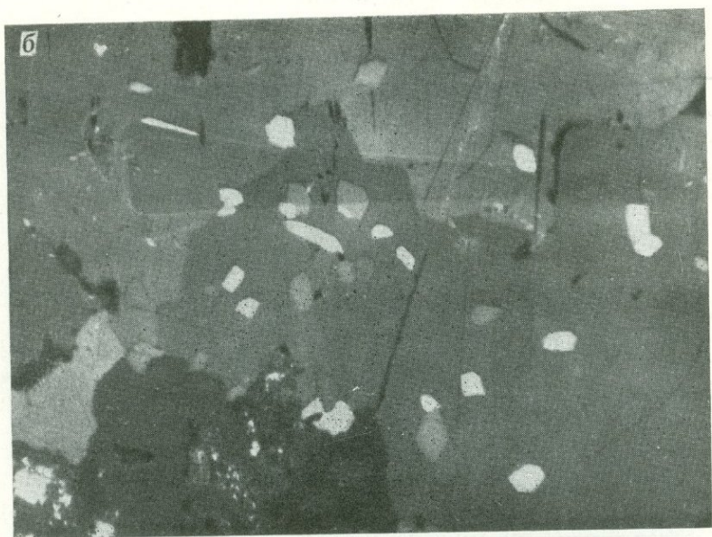
Рис. 96. Пойкилитовая структура срастания зерен киновари (серое) и антимонита (белое). Мелкие кристаллики антимонита являются более ранними образованиями. Месторождение Никитовка, Украинская ССР. Полированный шлиф: a — с одним николем; б — в скрещенных николях. Ув. 100
