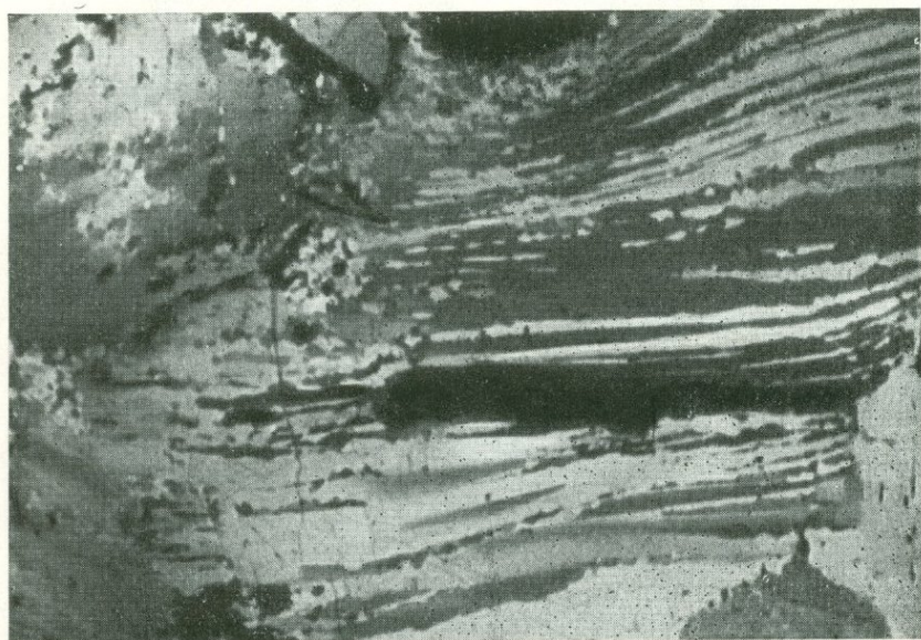
Рис. 83. Полисинтетические двойники давления в антимоните. Удерейское месторождение, Красноярский край. Полированный шлиф. Ув. 90
