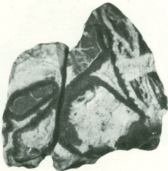
Рис. 41. Кокардовая, или кольчатая, текстура. Кольца сульфидов (черное) окружают обломки кварца (белое) и породы (темно-серое). Месторождение Целлерфельд, ГДР. Полированный штуф. По Ф. Н. Шахову. \frac{3}{4} нат. вел.
