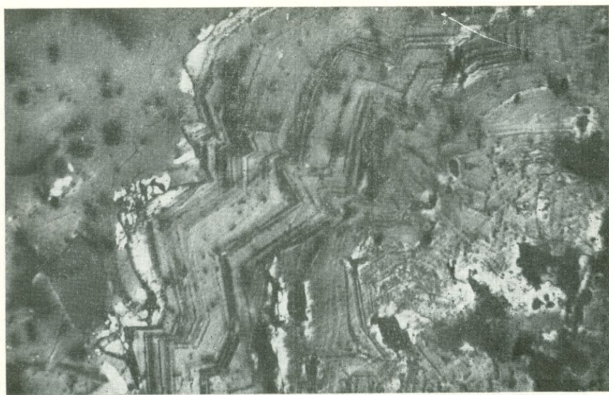
Рис. 109. Концентрически-зональная структура теннантита I (протравлено). Отдельные зоны сложены халькопиритом V (светло-серое), кварц (темно-серое). Пирит (белое), кварц (темно-серое). Месторождение Кафан, Армянская ССР. Полированный шлиф 2062. Ув. 165
