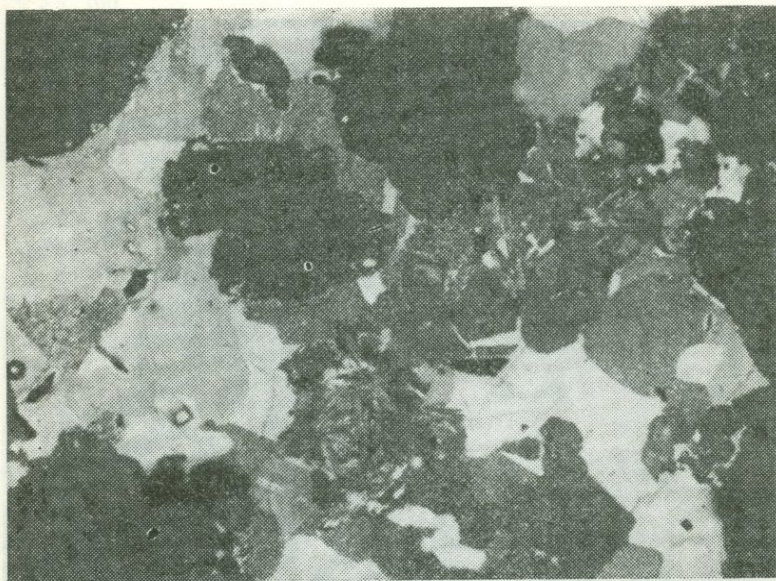
Рис. 20. Метазерна халькопирита (белое, серое, темно-серое) в породе. В халькопирите включены реликты нерудных минералов (почти черное, рельефное). Халькопирит протравлен в парах царской водки. Полированный шлиф. Ув. 70
