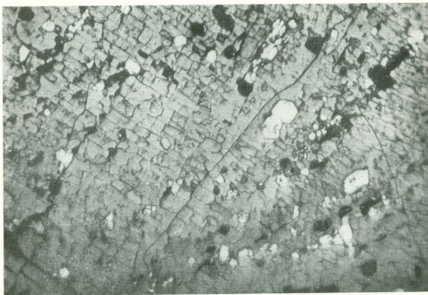
Рис. 115. Гранобластическая структура в борните I. Протравлен в реактиве I+KI. Реликты пирита (белое). Месторождение Кафан, Армянская ССР. Полированный шлиф 110. Ув. 320.
