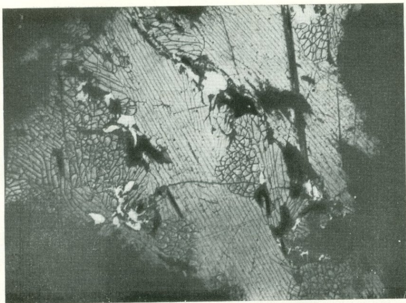
Рис. 72. Трещинки спайности в зернах цинкениита. Протравлен насыщенным раствором КОН в течение 40—60 мин. Месторождение Дарасун, Забайкалье. Полированный шлиф. Ув. 45
