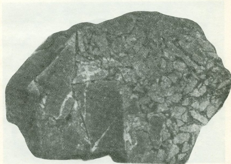
Рис. 14. Брекчиевидная текстура. Обломки измененного порфирита (серое) сцементированы молибденитом (черное); прожилки карбоната (белое). Месторождение Дастакерт, Армянская ССР. Полированный штуф
