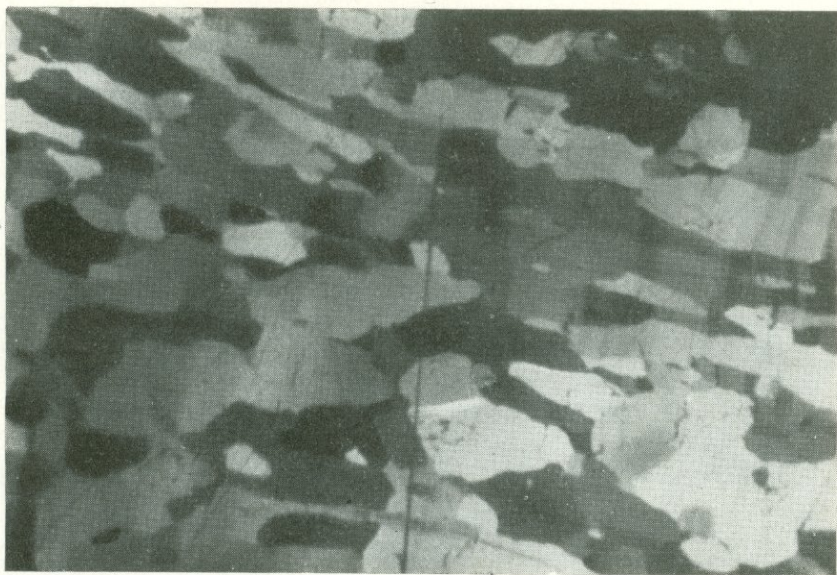
Рис. 117. Ориентированнобластическая структура в агрегате антимонита. Уд- рейское месторождение, Красноярский край. Полированный шлиф. Ув. 90
