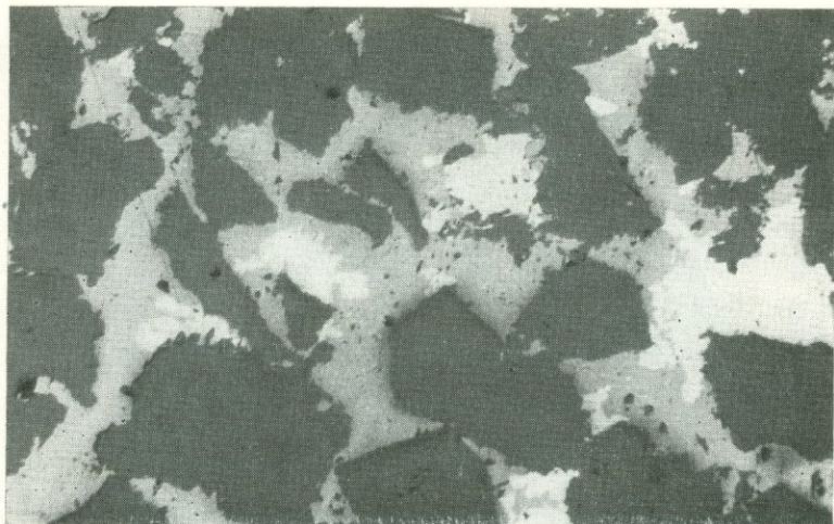
Рис. 45. Цементная унаследованная микротекстура. Обломки песчаника (серое и темно-серое) сцементированы халькопиритом (белое) и борнитом (светло-серое). Месторождение Джезказган, Казахская ССР. Полированный шлиф. Ув. 40
