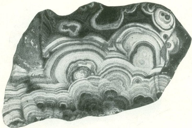
Рис. 33. Колломорфная и почковидная текстуры коллоидных агрегатов малахита. Структура агрегата концентрически-зональная. Месторождение Высокогорское, Урал. Полированный штуф
