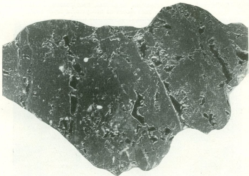
Рис. 65. Кавернозная текстура. Лимонит (темно-серое) с тонкими прожилками и вкрапленностью самородной меди (белое), с реликтами пирита, халькозина и куприта (светло-серое), с пустотками выщелачивания (черное). Месторождение Каджаран, Армянская ССР, карьер. Полированный штуф. Ув. \frac{2}{3} нат. вел.
