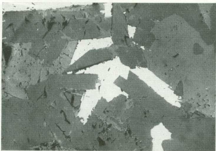
Рис. 95. Сидеронитовая структура. Идиоморфные и гипидиоморфные зерна пироксена (серое) и плагиоклаза (темно-серое) сцементированы пирротинном (белое). Месторождение Талнах Красноярский край. Полированный шлиф. Ув. 63
