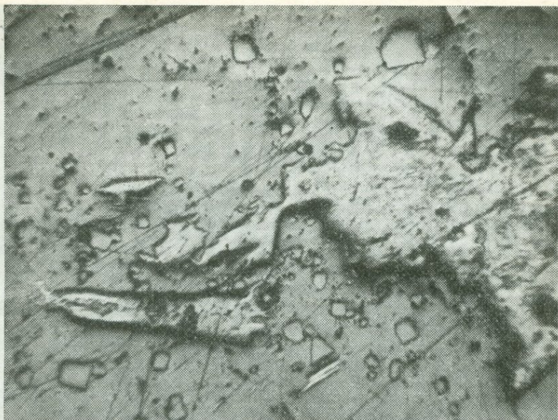
Рис. 44. Микротекстура разъедания. Теллуrowисмутит (белое) корродирует халькопирит V (светло-серое). Реликты пирита (рельефный, светло-серое). Место-рождение Кафан, Армянская ССР. Полированный шлиф. 86. Ув. 165
