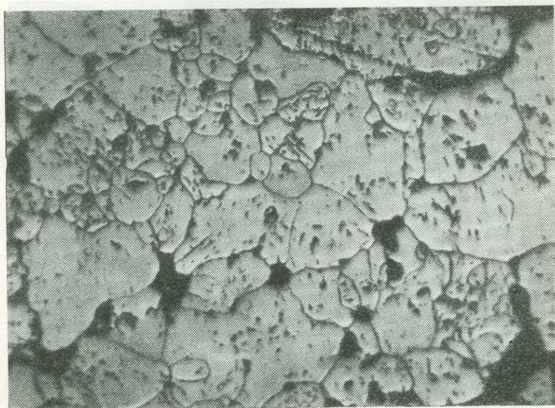
Рис. 18. Гранобластическая структура пиритового агрегата в обломках. Протравлен \text{HNO}_3 конц + \text{CaF}_2 в течение 3 мин. Полированный шлиф. Ув. 80
