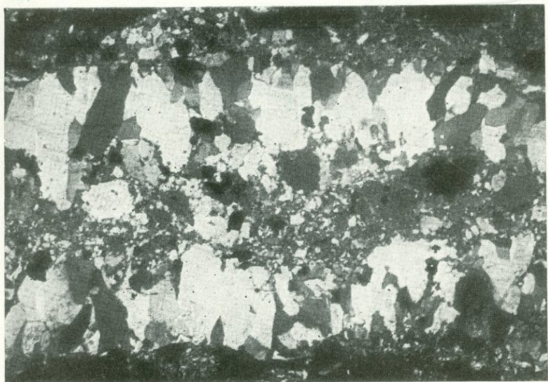
Рис. 93. Гребенчатая структура кварца. В центральную часть кварцевого прожилка проникает более поздний агрегат мелкозернистого кварца, хлорита и пирита. Месторождение Кафан, Армянская ССР. Прозрачный шлиф. В скрещенных николях. Ув. 5
