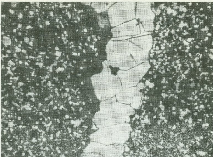
Рис. 9. Гранобластическая структура агрегата пирита (белое) в прожилке. Полированный шлиф. Ув. 40
