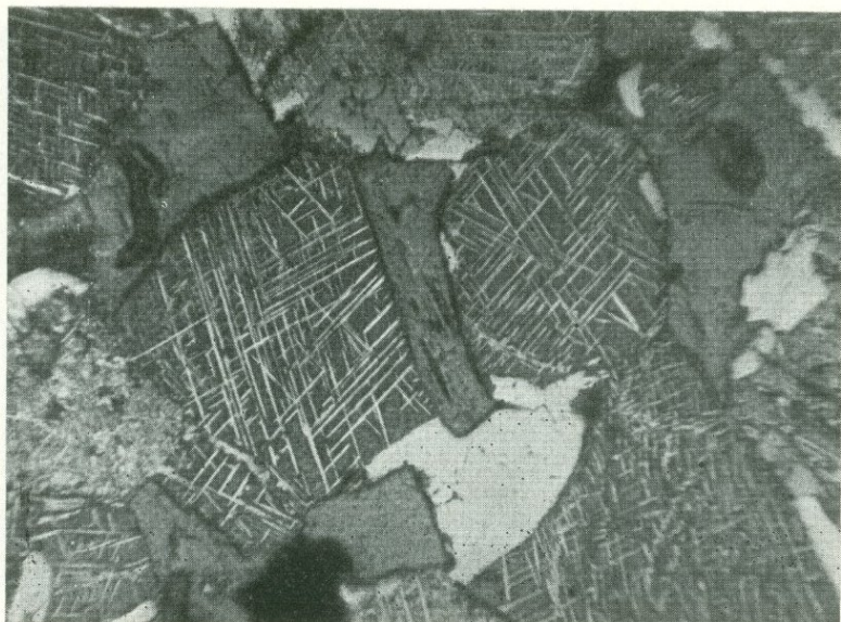
Рис. 90. Зерна магнетита (черное, протравлен HCl конц.) с решеткой ильменита (белое). Нерудный минерал (темно-серое). Месторождение Алексеевское, Забайкалье. Полированный шлиф. Ув. 90
