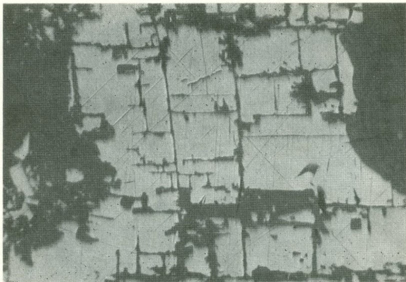
Рис. 58. Решетчатая микротекстура замещения галенита (белое) церусситом (черное). Месторождение Нерчинское, Забайкалье. Полированный шлиф. Ув. 40
