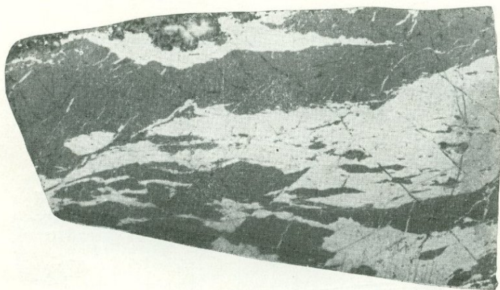
Рис. 13. Гнейсовидная и линзовидная текстуры медно-цинковой руды. Чередование полосок и линзочек сфалерита (черное) и халькопирита (белое). По трещинкам в сфалерите развиты просечки халькопирита. Вверху линзочки кварца (серое). Месторождение Карпушиха, Урал. Полированный штуф
