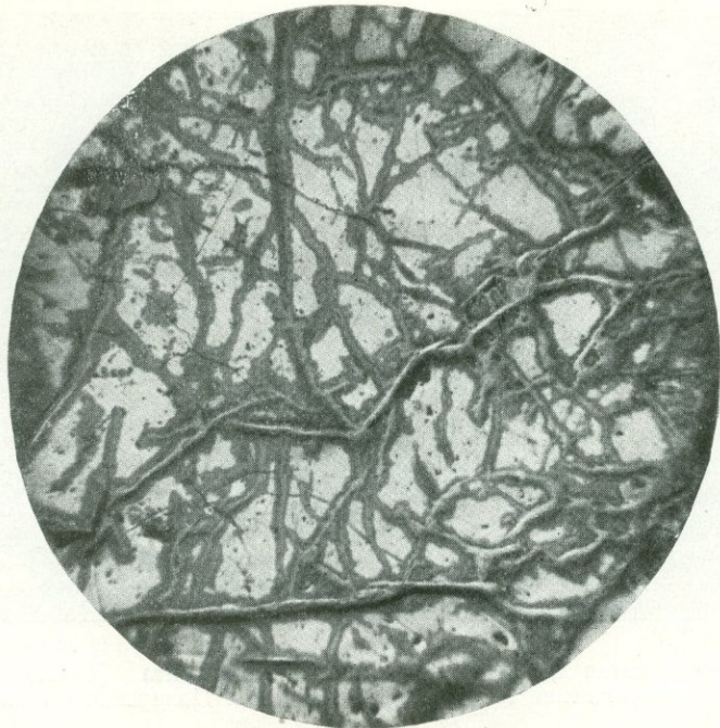
Рис. 56. Сетчатая микротекстура, образующаяся при замещении халькопирита (белое) гётитом (серое). Месторождение Левиха, Урал. Полированный шлиф. Ув. 40
