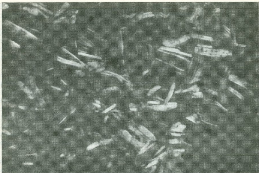
Рис. 27. Идиоморфнометазернистая структура агрегата молибденита. Метакристаллы молибденита (белое) развиты в роговике (черное). Месторождение Дастакерт, Армянская ССР. Полированный шлиф. Ув. 90
