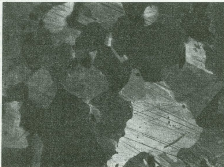
Рис. 28. Аллотриоморфнометазернистая структура агрегата халькопирита. Выявлена в парах царской водки. Месторождение Каджаран, Армянская ССР. Полированный шлиф. Ув. 90
