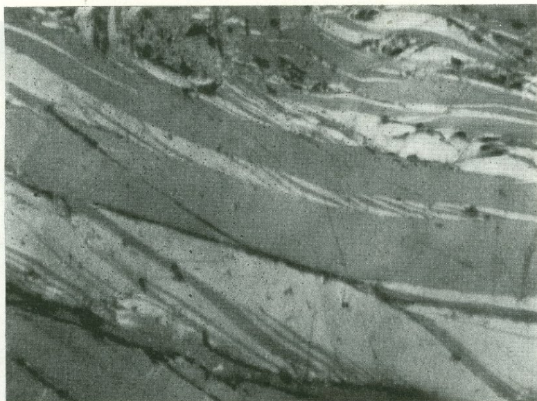
Рис. 85. Фигуры смятия развиваются по диагонали в пластинках молибденита. Месторождение Каджаран, Армянская ССР. Полированный шлиф. Николи скрещены. Ув. 40
