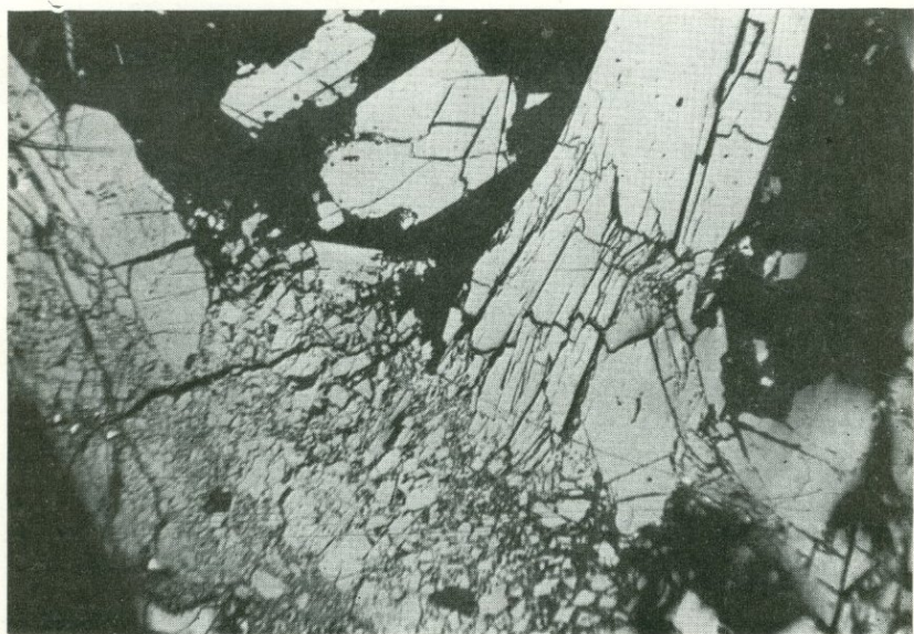
Рис. 132. Раздробленная структура в агрегате энаргита (белое). Диккит — черное. Месторождение Кафан, Армянская ССР. Полированный шлиф. Ув. 90
