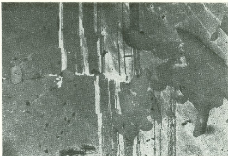
Рис. 103. Идиоморфнометазернистая структура. Метакристаллы кварца (темно-серые) в сфалерите (протравлен, полосы черного и серого цвета) приурочены к трещинкам дробления и пересекают двойники роста. Полированный шлиф. Ув. 70
