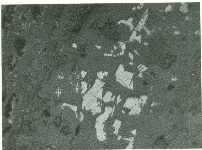
Рис. 105. Скелетная метазернистая структура. Метакристаллы куприта правильной и скелетной формы (белое) развиты в массе кальцита (темно-серое). Месторождение Анкаван, Армянская ССР. Полированный шлиф. Ув. 165
