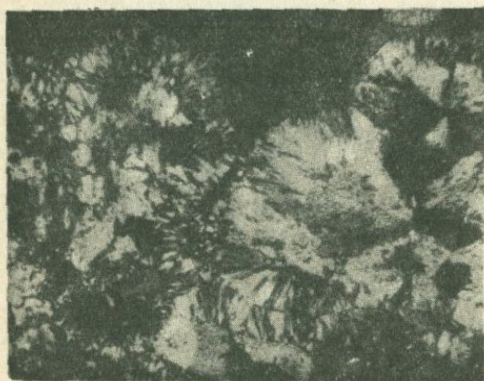
Фиг. 70. Кварц, переходящий в зонально развитый халцедон. Шлиф 46 /скв.92, глуб.210 м/. Увел. 72. Ник. х.
