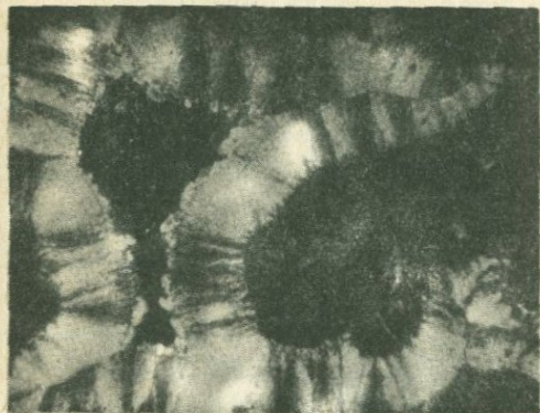
Фиг. 71. Апатитовые зерна /темно-серое/ окаймляются тридимитом волокнистого строения, который переходит в кварц. Шлиф 455 /скв. 69, глуб. 251 м/. Увел. 160. Ник. х.
