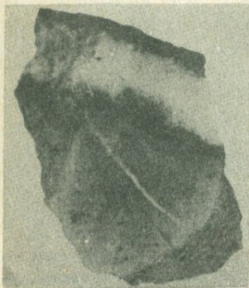
Фиг. 15. Магнетит-карбонатный прожилок с симметрично-зональным строением и развитием по зальбандам прожилка магнетита зернистого строения. Обр.448 /скв.69, глуб.170 м/.Нат.вел.
