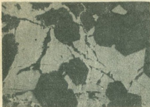
Фиг. 14. Магнетит /серое/ выполняет промежутки между кристаллами апатита /темное/. По контуру кристаллов апатита развит гематит /светлое/. Полир.шл.445 /скв.69, глуб.156 м/. Увел.400.
