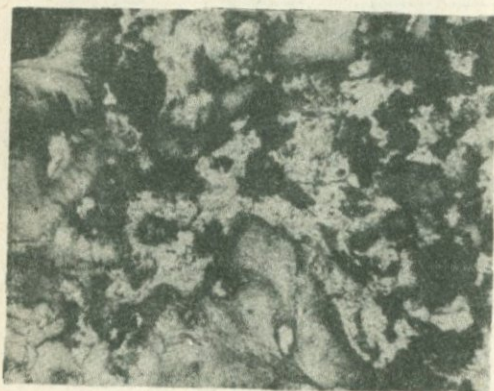
Фиг. 77. Развитие талька в кальцит-магнетитовом прожилке. Шлиф 40 /скв.92, глуб. 161 м/. Увел. 30. Без анализатора.
