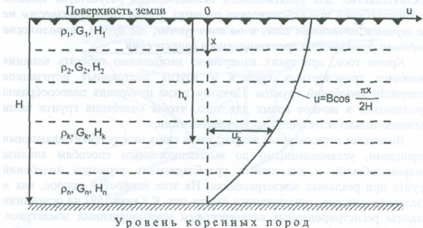
Рис. 2.18. Расчетная схема неоднородной толщи.
