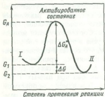
Рис. 8. Изменение свободной энергии твердого раствора при переходе из исходного состояния (I) со свободной энергией G_1 в конечное состояние (II) со свободной энергией G_2 ( \Delta G — движущая сила превращения; \Delta G_A^* — свободная энергия активации [28])
