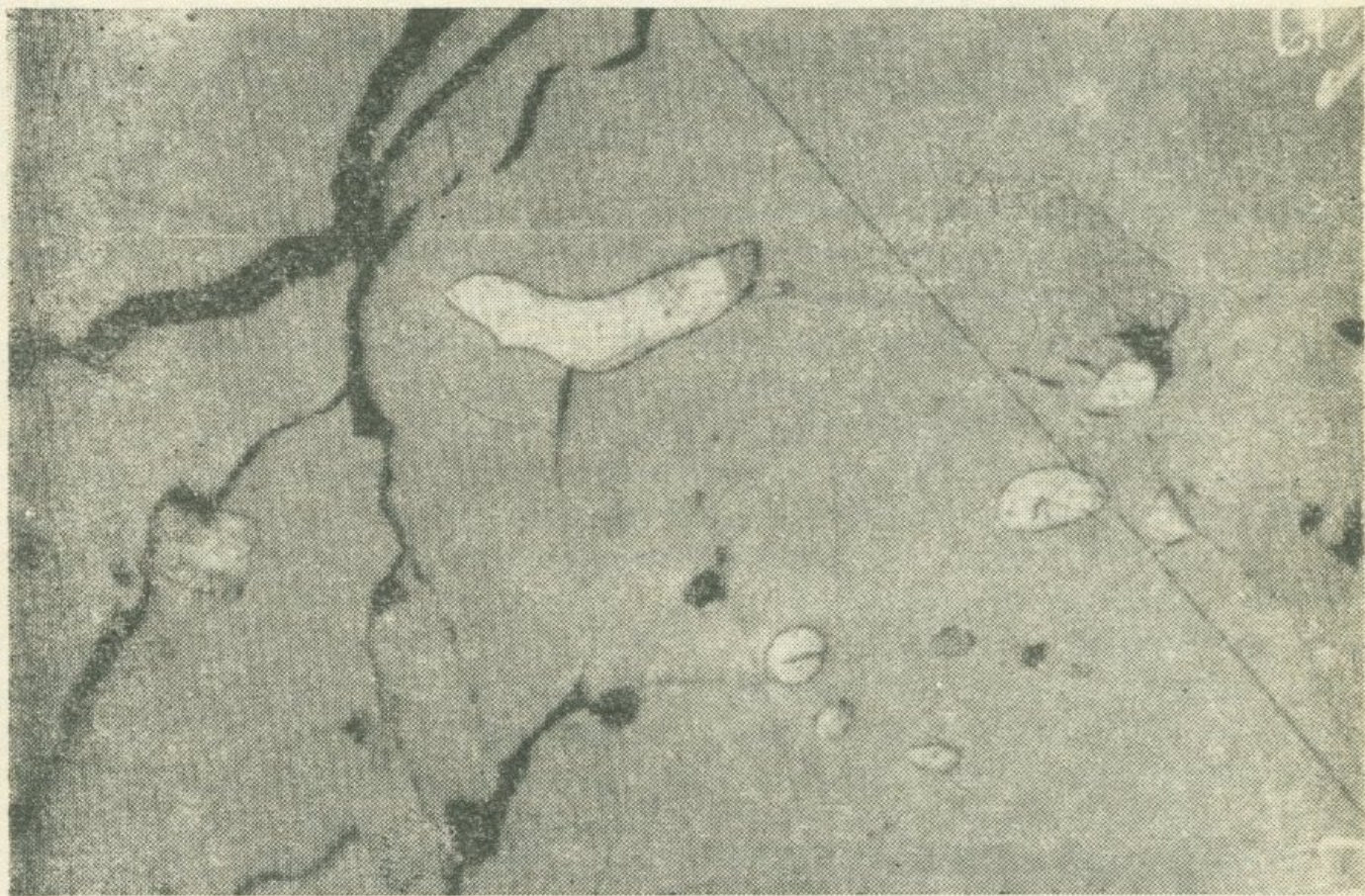
Рис. 12. Включения золота (белое) и гессита (темно-серое) в пирротине (общее поле). Зодское месторождение. Полированный шлиф, х 100.
