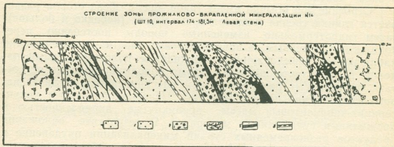
Рис. 3. Строение рудного тела. Меградзорское месторождение. 1. Слабо измененные монзониты. 2. Измененные гранодиориты. 3. Зоны брекчирования пород с прожилково-вкрапленной пирит-халькопиритовой минерализацией. 4. Серицитизированные, каолинизированные породы с прожилково-вкрапленной минерализацией. 5. Прожилки полиметаллической минерализации. 6. Сколовые нарушения с глиной трения.
