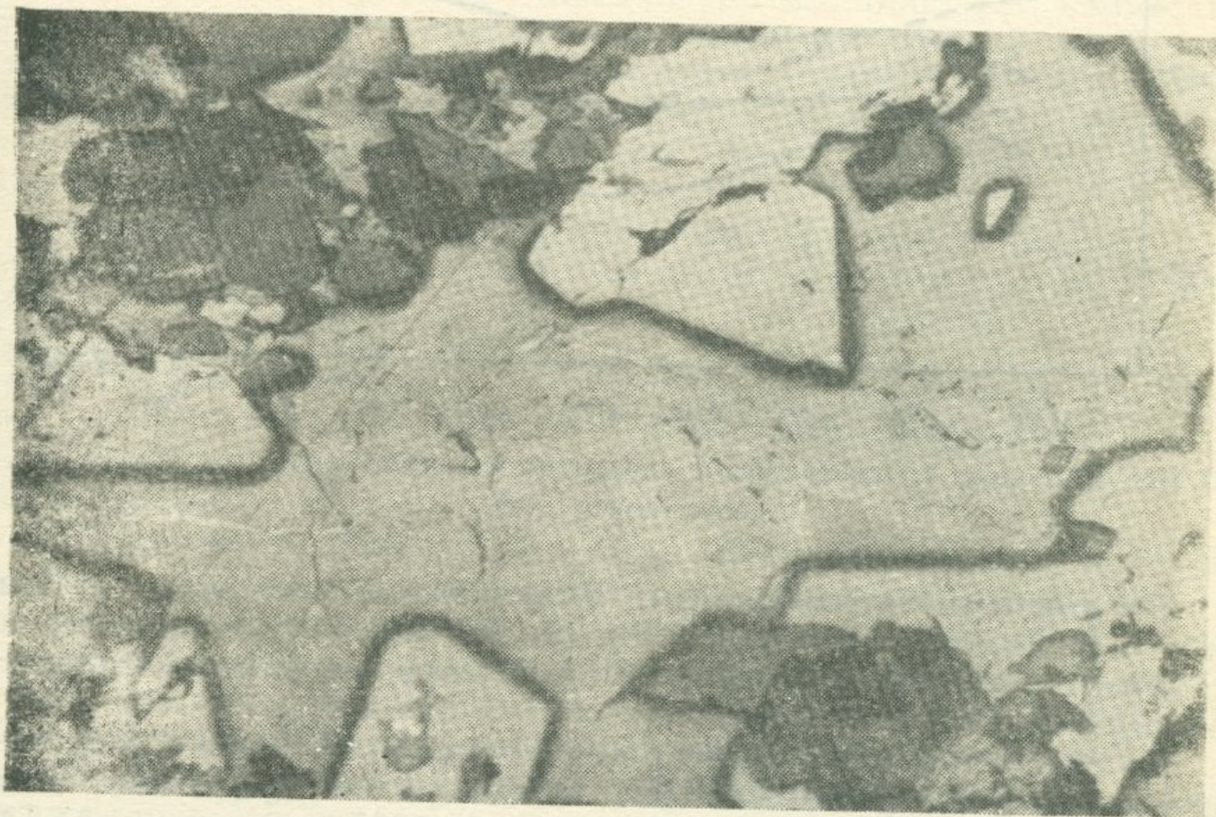
Рис. 21. Гессит с золотом выполняет друзовую полость, образованную идиоморфными выделениями вазсита. Серое, катаклазированное—хромит. Зодское месторождение. Поляр. шлиф. х 100.
