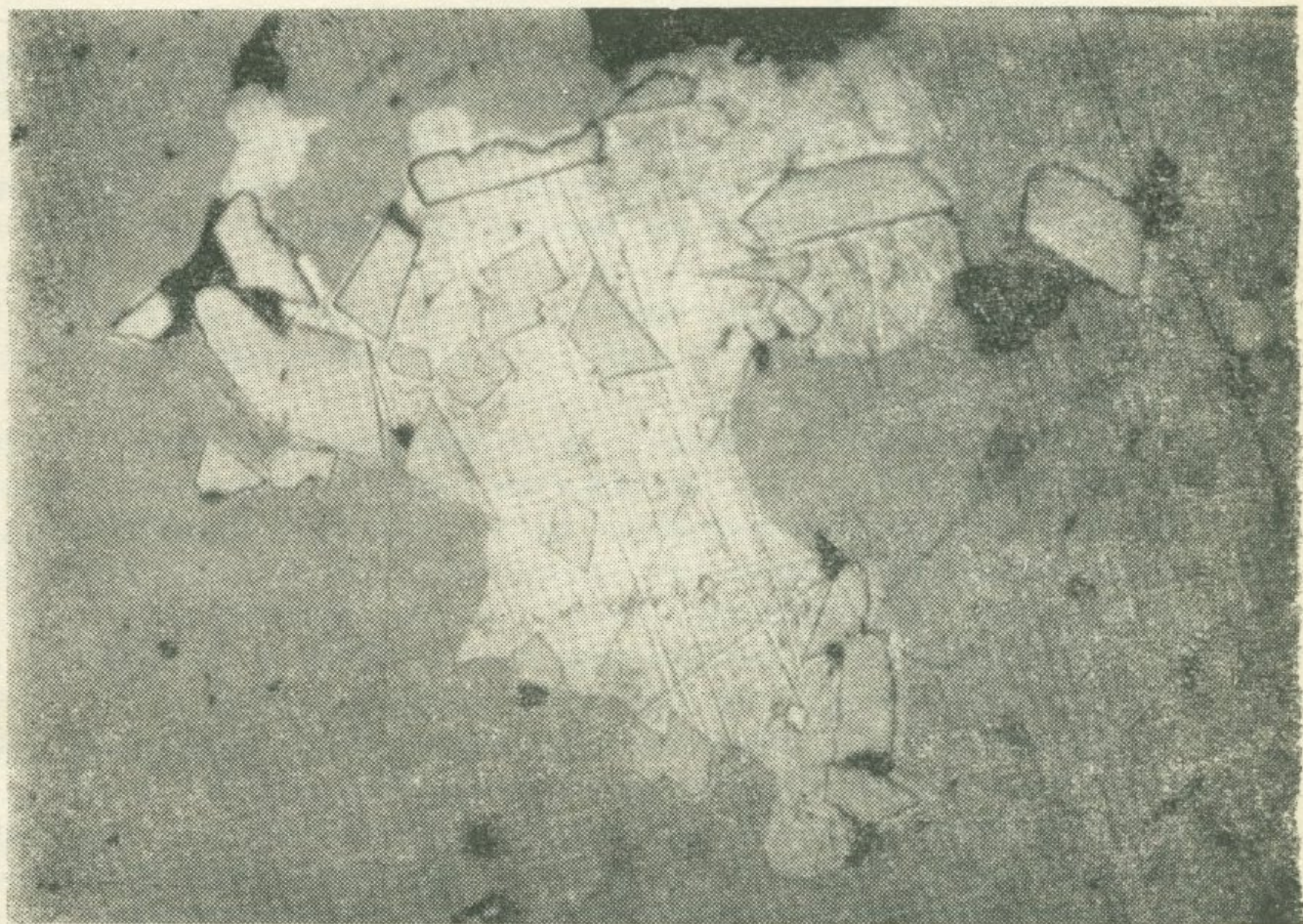
Рис. 16. Золото цементирует идиоморфные выделения арсенопирита в поле халькопирита. Тейское месторождение. Полированный шлиф. х 42.
