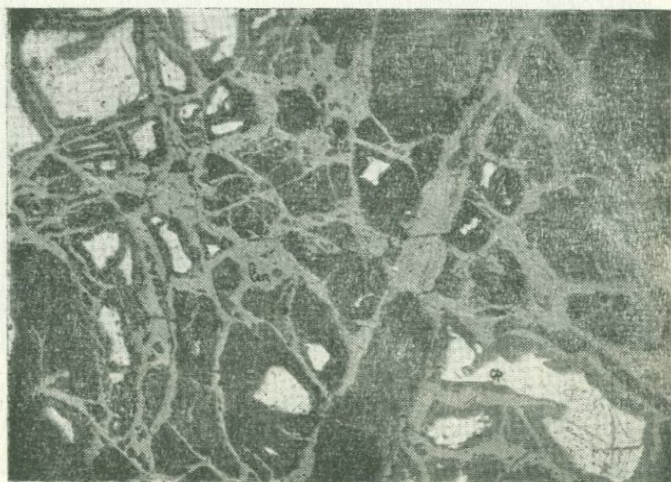
Фиг. 44. Ячеистая текстура лимонита (lm), образовавшегося за счет халькопирита (cp). \times 90 .
