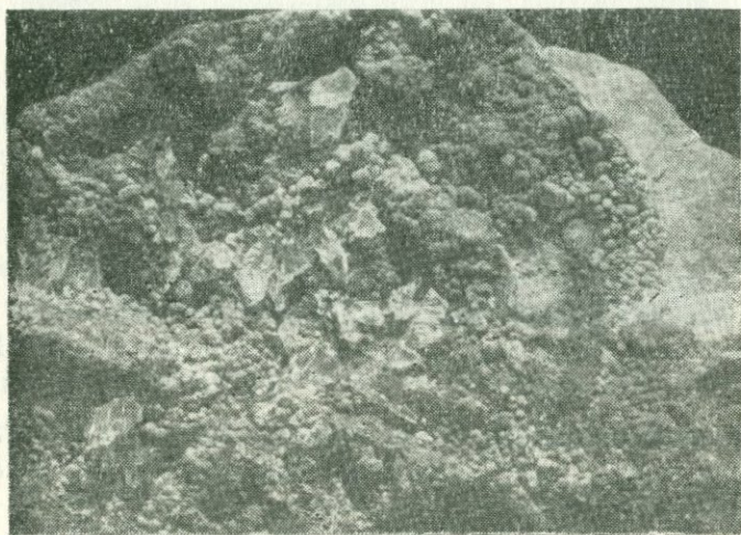
Фиг. 52. Кристаллические зерна белого гипса на почкообразной корочке малахита. \times 2 .
