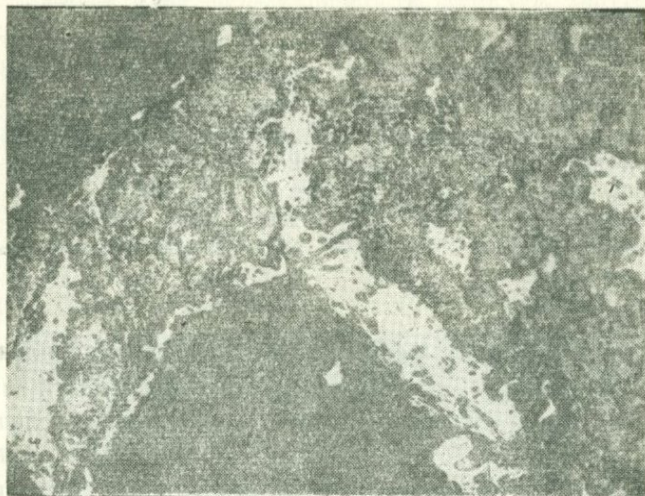
Фиг. 63. Шл. 184. Мегри-ли. Халькопирит (ср) заполняет промежутки между зернами магнетита (ml) и окаймляет их агрегаты. \times 46 .
