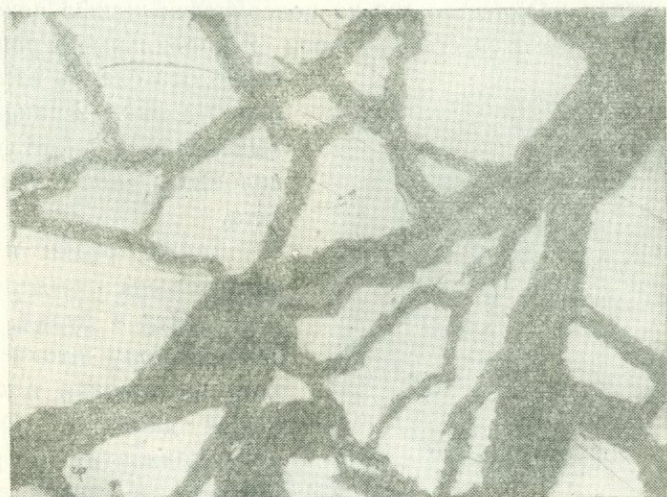
Фиг. 71. Шл. 8/47. Отвал штольни 1. Петельчатая микротекстура замещения халькопирита (ср) лимонитом (lm), халькозином (сс) и ковеллином (cv). Внутри трещин развивается лимонит, по периферии халькозин и ковеллин. \times 240 .
