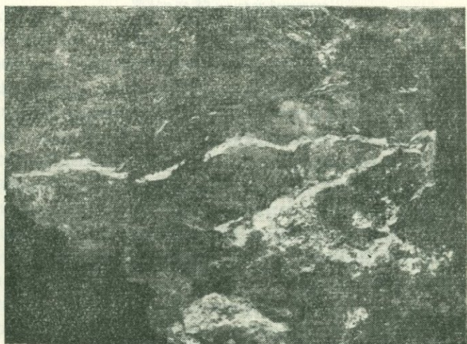
Фиг. 56. Ярозитовые прожилки в лимонитизированной породе. \times 2 .
