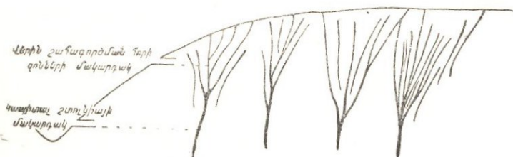
Նկ. 82. Ղափանի հանքավայր Հանքային երակների սեպածե մարման և միացման սխեման (№ 6 հանքի կտրվածք):
