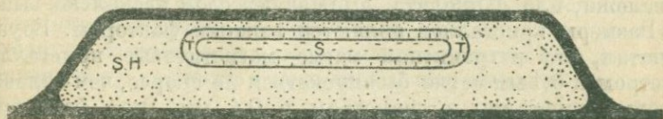
Рис. 50. Дифференциация в лакколите Шонкин Сэг (Shonkin Sag). Диаграмма поясняет распределение типов горных пород внутри лакколита. Черная каемка обозначает контактовую породу (лейцитовый базальтовый порфир); SH — шонкинит; T — переходная порода; S — сиенит. Все разновидности переходят постепенно одна в другую. Вертикальный масштаб в шесть раз больше горизонтального. По А. Харкеры, Natural History of Igneous Rocks .
