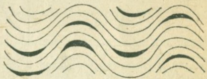
Рис. 15. Факолиты. Схема, иллюстрирующая места факолитов в антиклиналях и синклиналях.
