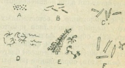
Рис. 35. Кристаллиты и микролиты. А — глобулиты; В — маргариты; С — лонгулиты; D — трихиты; E — скопулиты; F — микролиты. Увел. приблизительно в 200 раз.
