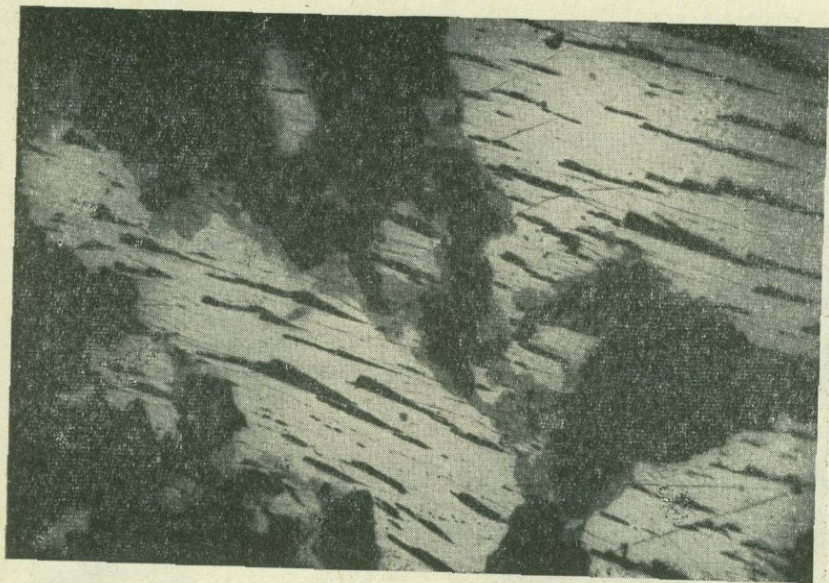
Фото 75. Структура краевых каемок халькопирита (темно-серое) по краям выделений галенита (светлое). В галените видны треугольники выкрошивания. Дастакертское месторождение. Полированный шлиф. Ув. 40.
