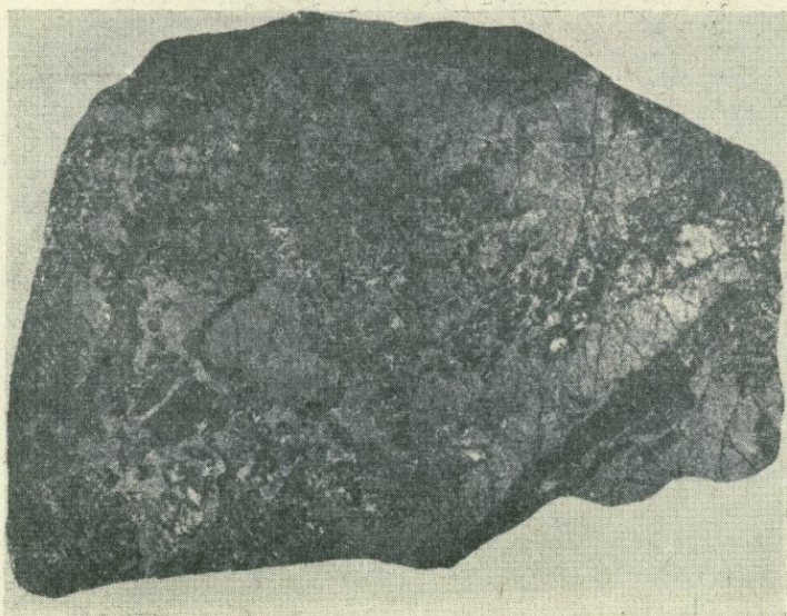
Фото 110. Брекчиевидная текстура замещения борнитовой руды полевошпат-кварц-халькопиритовой стадии минерализации. Темное—вмещающая порода, серое—борнит.
