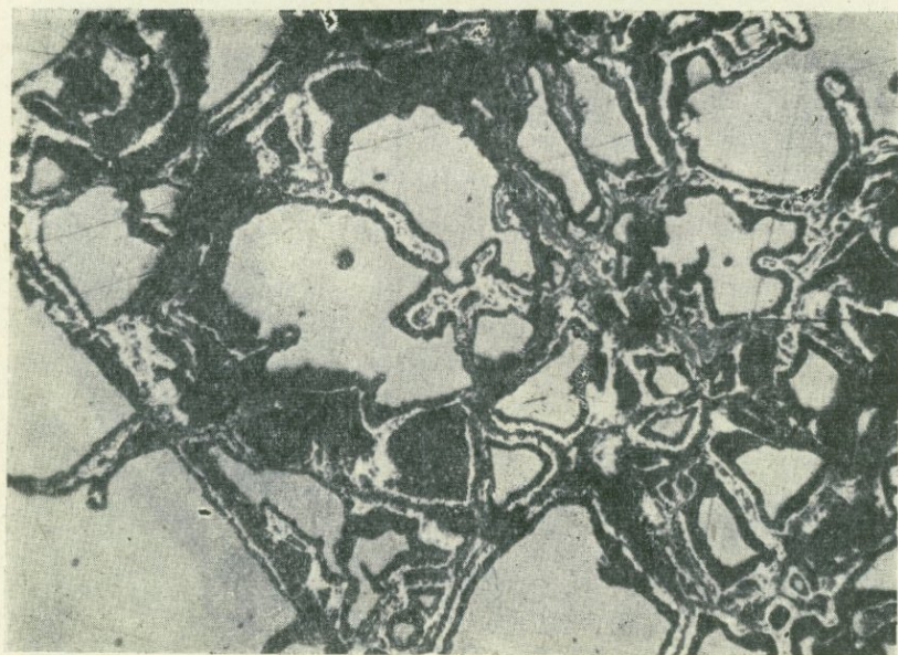
Фото. 143. Структура краевых оторочек мельниковита вдоль границ алабандина. Видно проникновение мельниковит-пирита во внутрь полей алабандина, Дастакертское месторождение. Полированный шлиф. Ув. 90.
