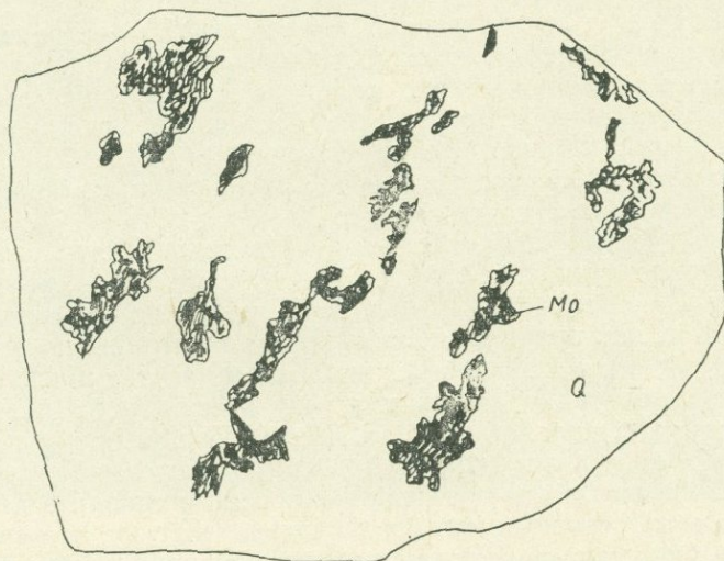
Рис. 23а. Пятнистая текстура в кварц-молибденитовой жиле. Пластинчатые агрегаты молибденита образуют пятнистые скопления в кварцевой жильной массе.
