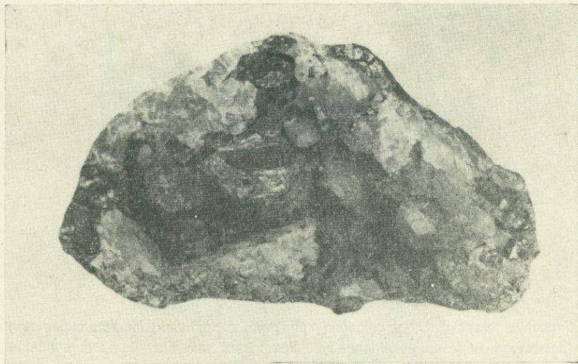
Фото 33. Участок друзовой текстуры в кварц-молибденитовом прожилке.
