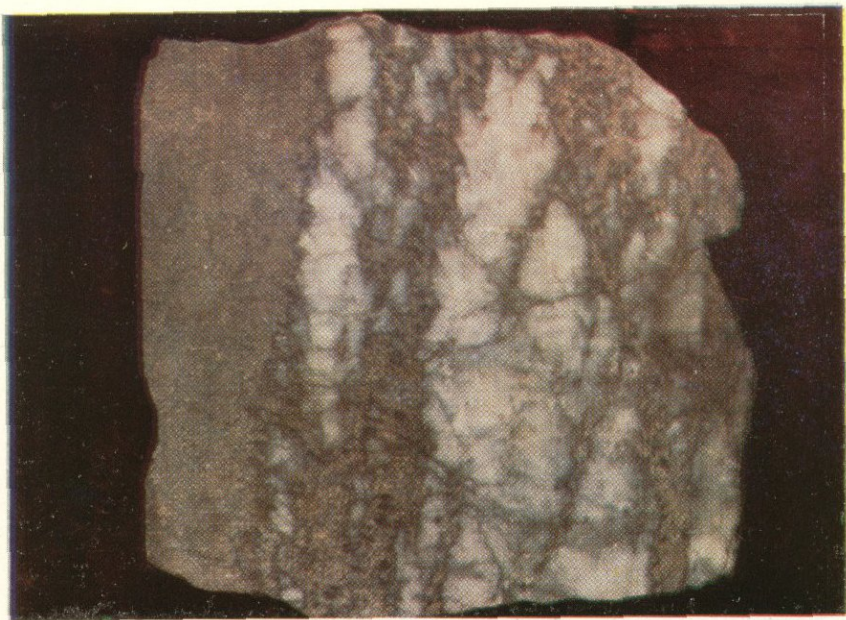
Табл. IV(3). Брекчиевая текстура руд в кварц-молибденитовой жиле Айгедзорского месторождения. Кварц раздроблен и сцементирован пиритовой рудой. Айгедзорское месторождение. Натуральная величина.
