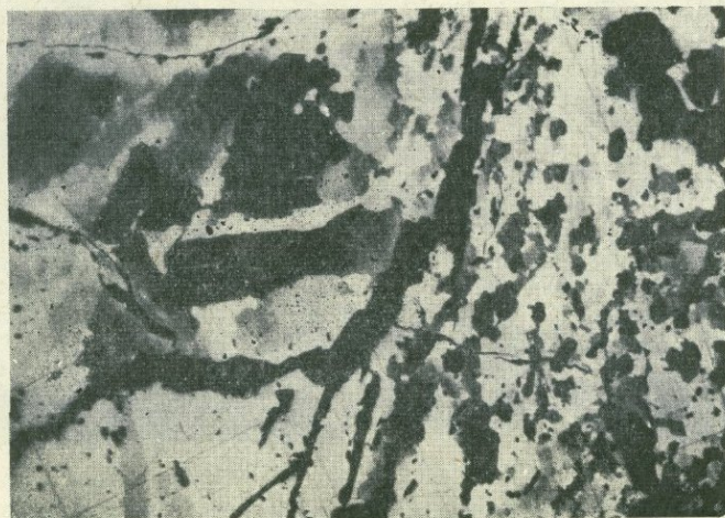
Фото 159. Призальбандовая часть халькопиритового прожилка, подвергшаяся метаморфизму. Справа гранулированная полоса. Результат пластической деформации. Каджаранское месторождение. Полированный шлиф. Ув. 90.
