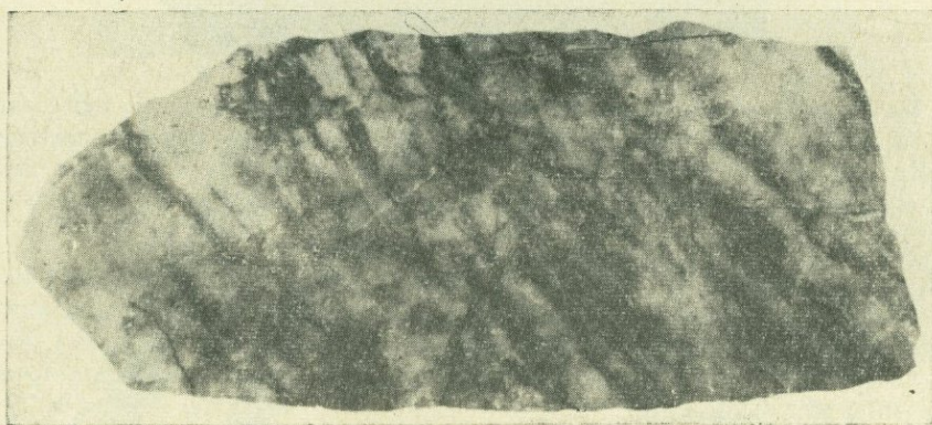
Фото 17. Полосчатая текстура в кварц-молибденитовой жиле. Неправильные прожилкообразные выделения молибденита в кварце в сочетании с вытянутыми контурами темного кварца обуславливают полосчатость в жиле. Каджаранское месторождение. 1/2 натуральной величины.
