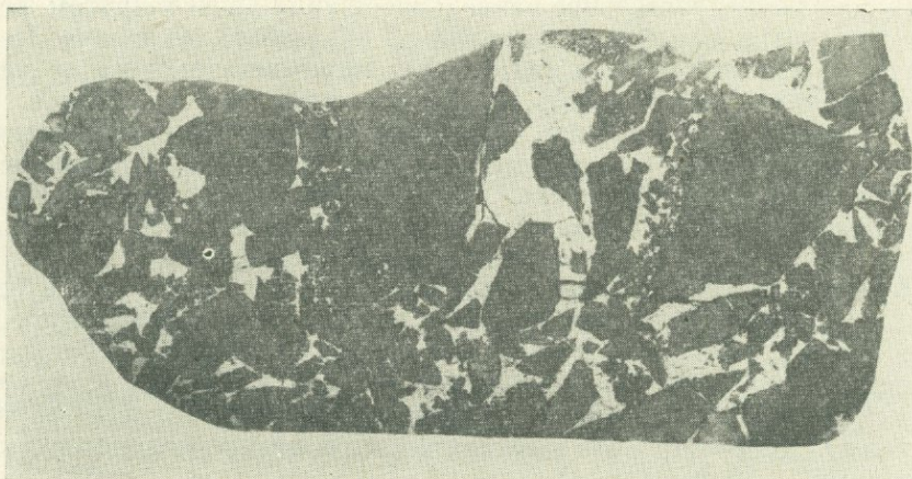
Фото 36. Брекчиевая текстура руд полевошпат-кварц-халькопиритовой стадии минерализации. Обломки контактовых роговиков сцементированы халькопиритом. Дастакертское месторождение. 1/2 натуральной величины.
