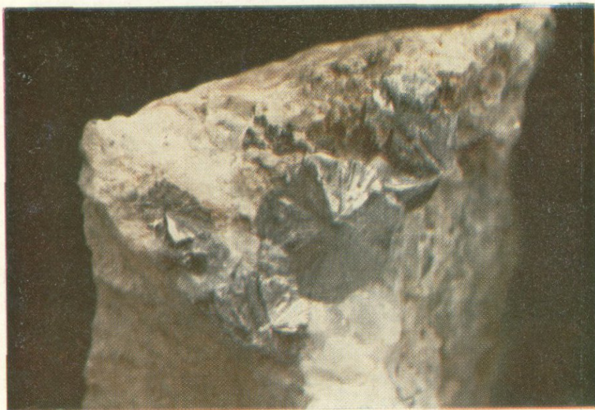
Табл. I(2). Сферолитоподобный агрегат молибденита в кварцевом прожилке. Агаракское месторождение.
