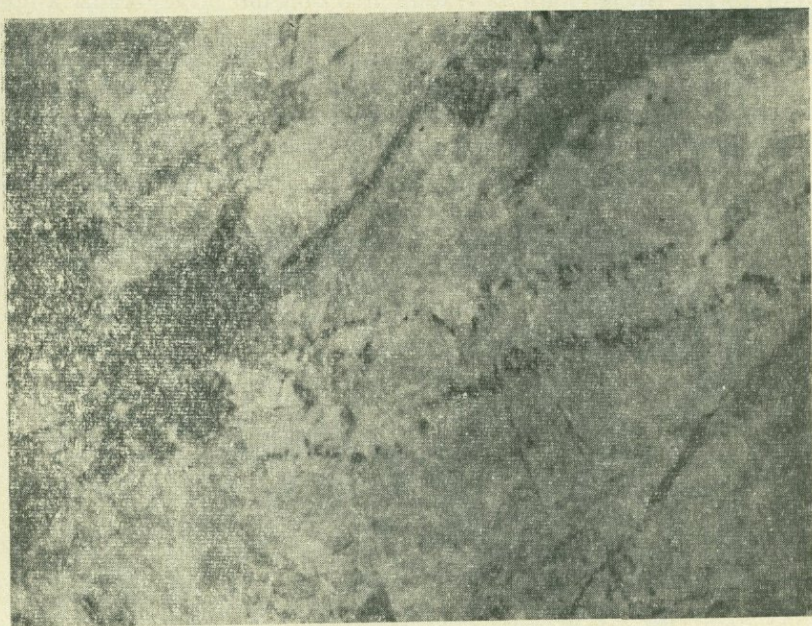
Фото 16. Полосчатое строение кварц-молибденитовой жилы. Молибденит образует чешечки, расположенные параллельно зальбандам жилы. Каджаранское месторождение. Фото забоя.
