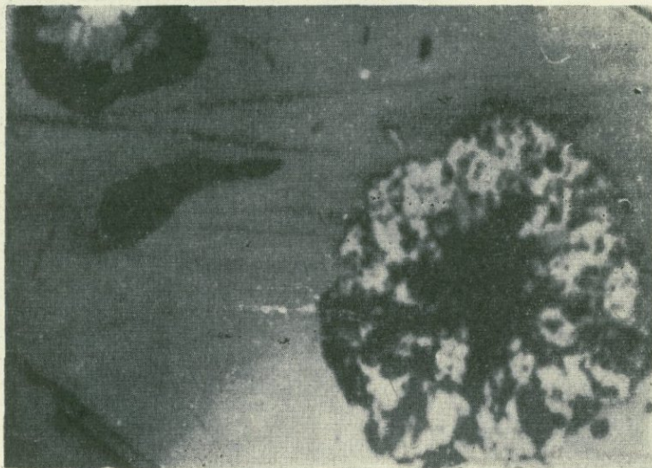
Фото 142. Сферические стяжения пирита в халькопирите, образованные в результате наложения пиритовой минерализации на халькопиритовую. Тейский участок Айгедзорского месторождения. Полированный шлиф. Ув. 180.
