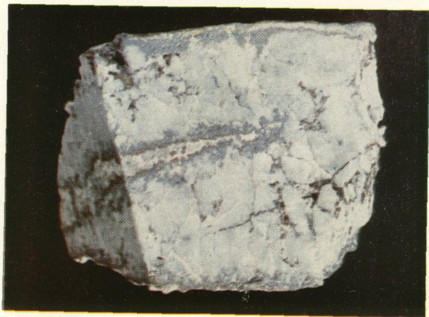
Табл. II(2). Огорочка молибденита вдоль зальбанд жилы I—I, а также вдоль обломков вмещающей породы II.
