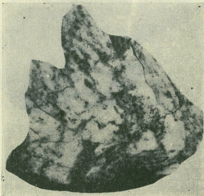
Фото 134. Псевдогнездовая и псевдовкрапленная текстура ангидрит-сульфидных руд. Темные неправильные очертания сульфидов в полях ангидрита. Джиндаринское месторождение. Натуральная величина.
