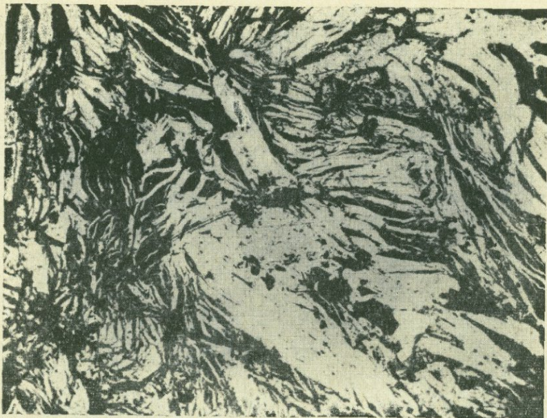
Фото 155. Структура смятия молибденита в кварц-молибденитовом прожилке. Каджаранское месторождение. Полированный шлиф. Ув. 40.
