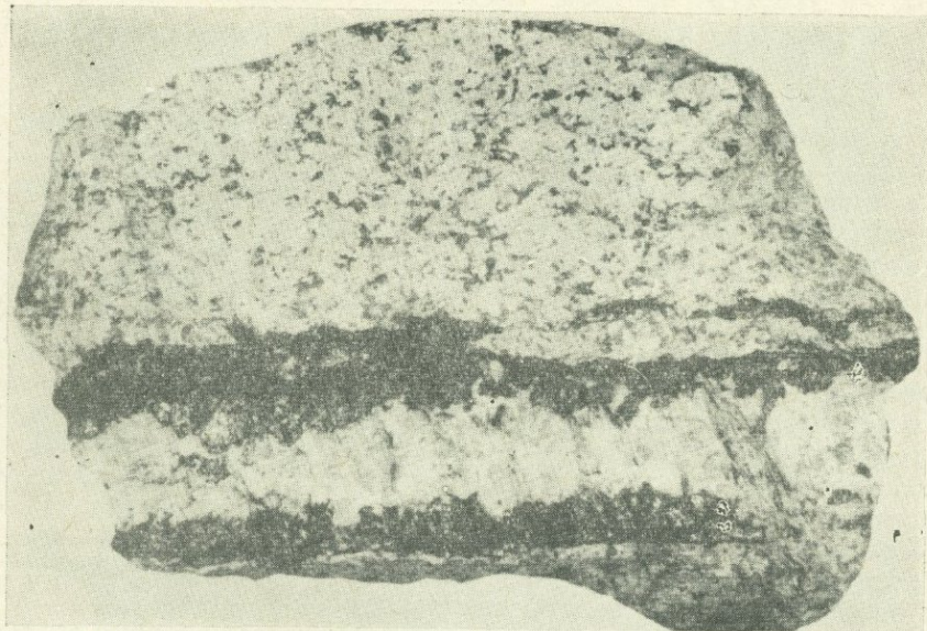
Фото 26. Текстура зальбандовой оторочки кварц-молибденитовой жилы. Молибденит выделился раньше кварцевой жильной массы вследствие взаимодействия раствора с вмещающей породой. Каджаранское месторождение. 1/2 натуральной величины.
