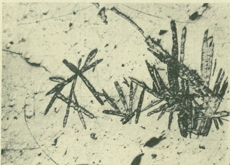
Фото 57. Гипидиоморфнозернистая структура массивной халькопиритовой руды. Гематит образует идиоморфные и пластинчатые агрегаты. Каджаранское месторождение. Полированный шлиф. Ув. 90.
