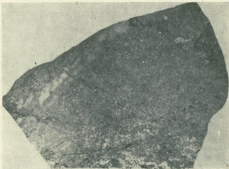
Фото 104. Вкрапленная текстура минеральных образований кварц-халькопирит-борнитовой стадии минерализации. Джиндаринское месторождение. Вмещающие породы интенсивно окварцованы. Натуральная величина.
