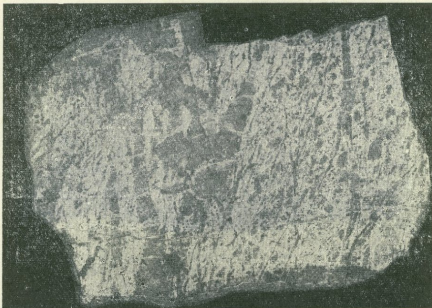
Фото 115. Прожилково-вкрапленная текстура кварц-халькопиритовой минерализации. Основная масса халькопирита рассеяна во вмещающей породе. Незначительная часть сосредоточена в кварцевых прожилках. Каджаранское месторождение. Натуральная величина.
