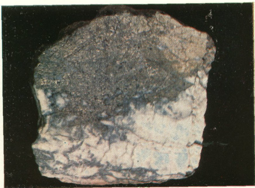
Табл. IV(4). Интенсивное замещение кварц-молибденитовой жилы пиритовой рудой. Айгедзорское месторождение. 1/2 натуральной величины.
