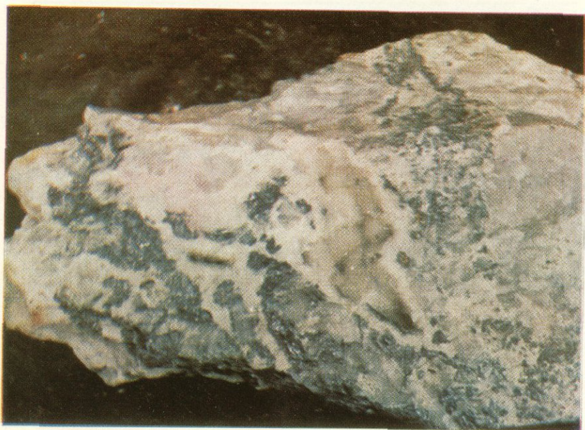
Табл. V(2). Текстура замещения кварц-молибденитовой руды карбонатной минерализацией. Видны остатки от замещения кварца и молибденита в карбонате. Каджаранское месторождение. Натуральная величина.
