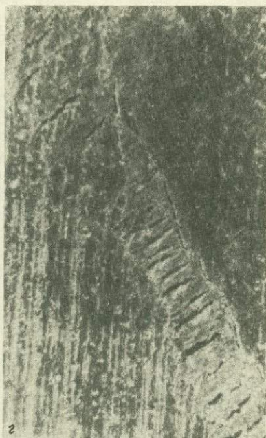
Рис. 1. Эшелоны трещин, предваряющих образование макроразрыва сдвигового типа
