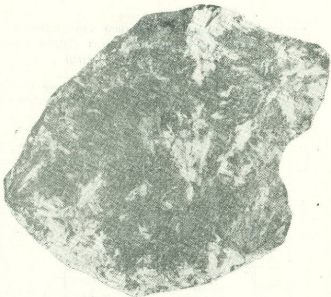
Фиг. 16. Деформированные кристаллы антимонита, сцементированные баритом
