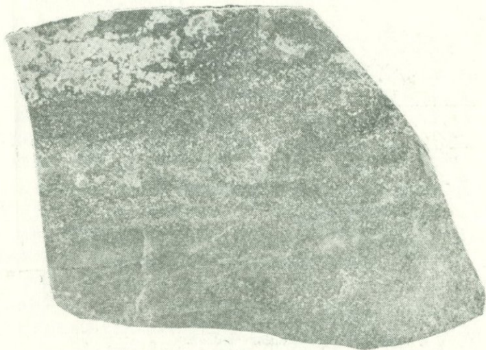
Фиг. 21. Тонкополосчатая текстура сульфoантимонитовой руды с колломорфными выделениями минералов: пирита, сфалерита, галенита.
