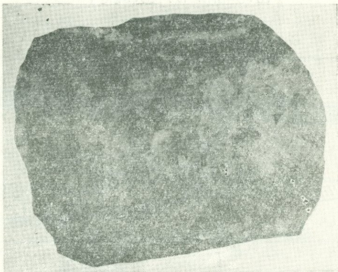
Фиг. 20. Асимметричное строение кварц-антимонитовой жилы: нижняя часть сложена радиально-лучистыми кристаллами антимонита, средняя — кварцем, верхняя — пиритом и сфалеритом
