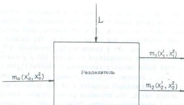
Рис. 12. Функциональная схема разделителя.
