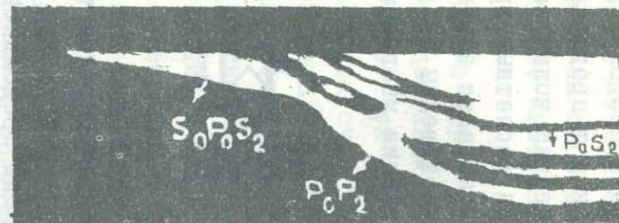
Рис. I Типы волн в слоистой среде при падении цилиндрической волны P на жесткую границу:
