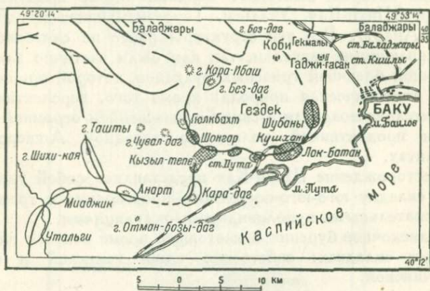
Рис. 12. Тектоническая карта Западного Апшерона и Восточного Кабристана (по И. М. Губкину и позднейшим данным треста Азнефтегазразведка). Эксплуатируемые месторождения заштрихованы, разведываемые оставлены белыми.
