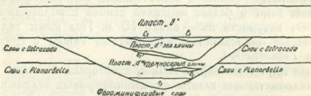
Рис. 5. Схематический разрез горизонта легкой нефти.
