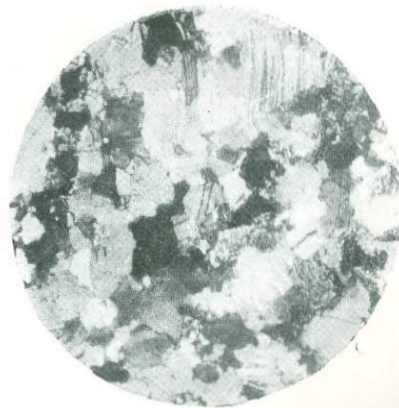
Фиг. 24. Лабрадорит гранато-пироксеновый. Видна «Mörtel-Struktur» у плагиоклаза. Обр. № 164. Ник. +. Увел. 25 раз.
