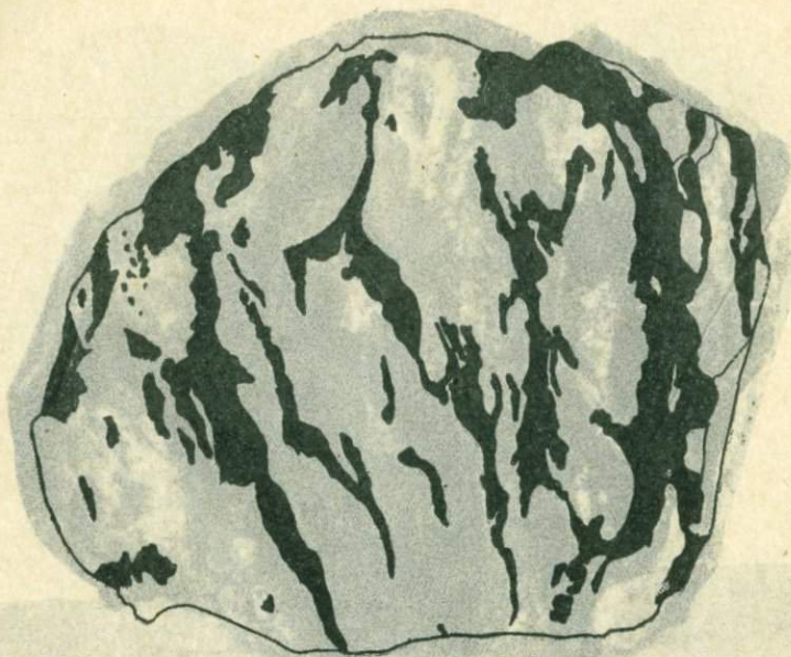
Фиг. 18d (Обр. № 497, нат. величина). Ловчоррит залит тушью. Черное — эгирины и щелочной амфибол. Белое и серое — главным образом полевоы шпаты и нефелин. Текстура прерывисто-полосчатая. Западная часть участка «3 жила». «Первомайская» жила. Пегматитовая жильная порода. Уд. вес 3.11.
