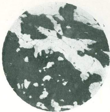
Фиг. 19б. || NN. Белое — ловчоррит. Черное — эгириин и щелочный амфибол. Пойкилитическая структура. Уч. «5 жил». «Первомайская» жила на гор. шт. № 3. Обр. № 497. Шлиф № 156в \times 25 .
