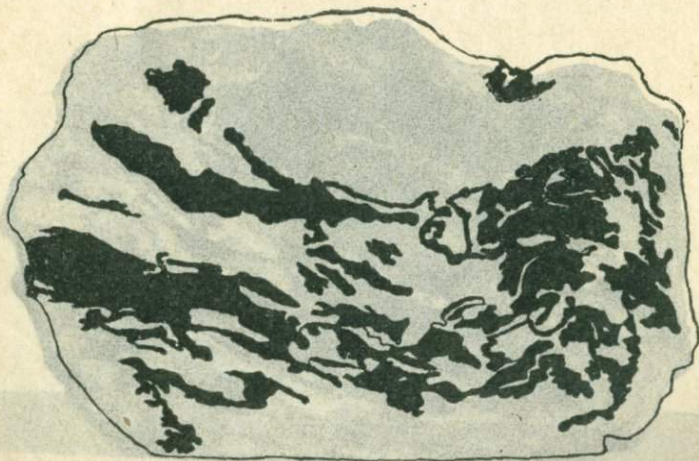
Фиг. 18с. (Обр. № 485, пат. величина). Ловчоррит залит тушью. Черный — эгирин и целочный амфибол. Белое — главным образом сфен и нефелин. Изоморфные кристаллы сфена заключены в ловчоррите. Текстура полосчатая. Перманитовая ловчорритно-ринколитоидная жила в ринчорритах.
