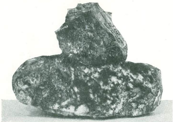
Фиг. 18б. (Обр. № 510 и № 488, нат. величина). Ловчоррит залит тушью, на фото серо-черный. Белое главным образом полевой шпат, очень мало нефелина. Эгирин и щелочного амфибола так же мало — черное. Текстура массивная. Типичная пегматитовая жильная порода. Уд. вес 2.9. Обр. № 510 — участок «3 жилы» на горизонте шт. № 3 — «Августовская» оруденелая зона. Обр. № 488 — жила «Над компрессорной».
