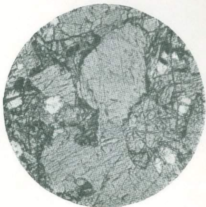
Фиг. 26. Амфиболизированный перидотит. Пироксен целиком перешел в слабоплеохроичный амфибол, в промежутках зерна оливина. Обр. № 49. Ник. ||. Увел. 25 раз.
