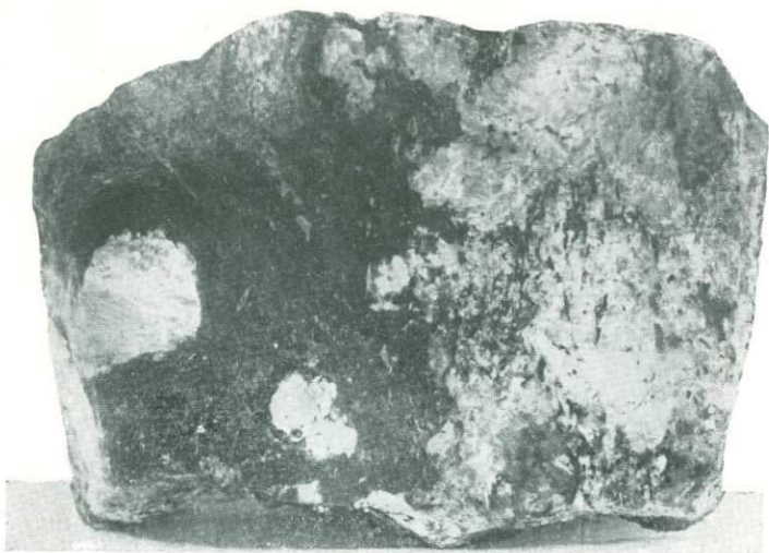
Фиг. 18а. (Обр. № 503, 0.75 нат. величины). Ловчоррит залит тушью. Белое — полевой шпат, серое — нефелин, черное — эгирин и щелочный амфибол. Текстура массивная, несколько полосчатая. Типичная пегматитовая жильная порода. Уд. вес № 2.85. Восточная часть участка «3 жилы».
