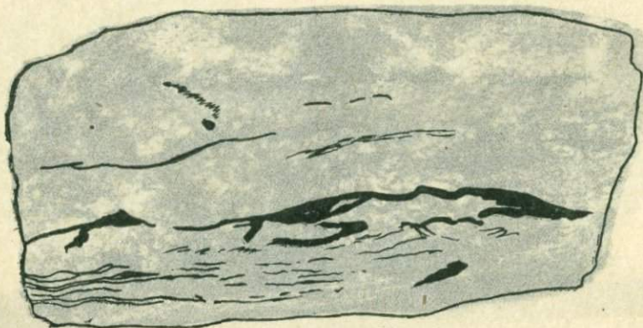
Фиг. 18e. (Обр. № 493, нат. величина). Ловчоррит залит тушью. Остальное — гнейсовидный, эгирино-роговообманковый нефелиновый сиенит. Текстура гнейсовидная. Типичный облик для вмещающей породы, входящей в состав сложных жил. Уд. вес 2.82. Западная часть участка «3 жила». «Первомайская» жила.
