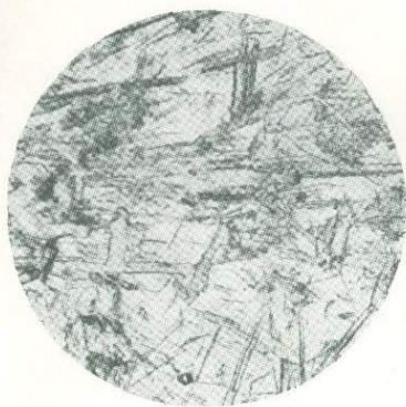
Фиг. 19д. Иглы и призмы ринколита в калиевом полевоом шпате и альбите. Пойкилитическая структура. Участок «5 жил». «Первомайская» жила на гор. шт. № 3. Обр. № 497. Шлиф № 156в. \times 25 .
