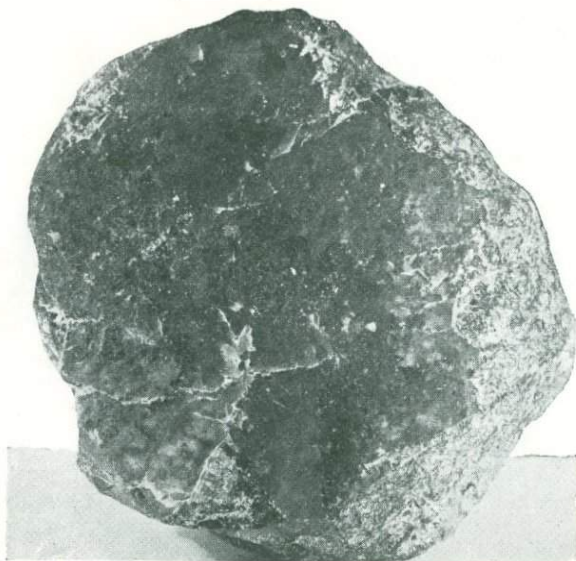
Фиг. 18в. (Обр. № 435, 0.5 нат. величины). Ловчоррит залит тушью. Остальное порфировидный агирино-роговообманковый нефелиновый сие-нит, с повышенным содержанием темноцветных минералов. Текстура массивная. Типичная для оруденелой зоны руда. Уд. вес 3.07. Учет-сток «3 жилы» на горизонте шт. № 3— «Августовская» оруденелая зона.
