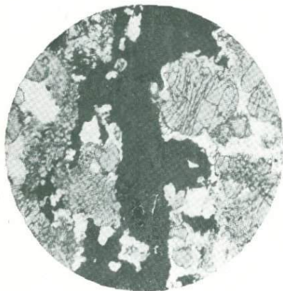
Фиг. 17. Характер распределения магнетита в амфиболите. Обр. № 289. Ник. ||. Увел. 25 раз.
