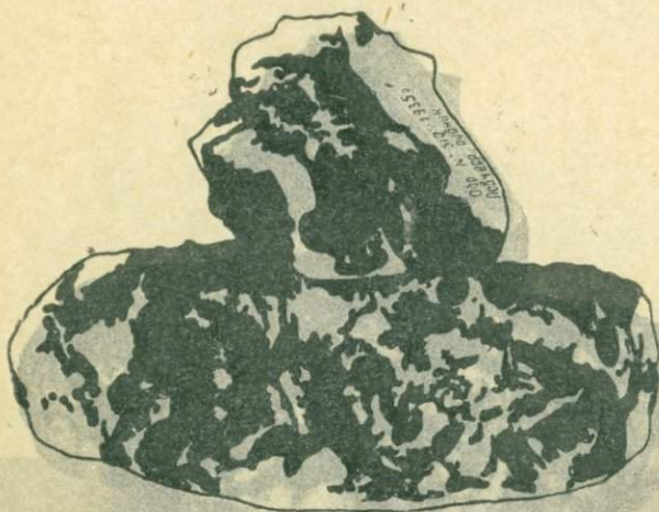
Фиг. 18а. (Обр. № 503, 0,75 нат. величины). Ловчоррит залит тушью. Белое — полевой шпат, серое — нефелин, черное — эгирин и щелочный амфибол. Текстура массивная, несколько полосчатая. Типичная пегматитовая жильная порода. Уд. вес № 2.85. Восточная часть участка «5 жил».
