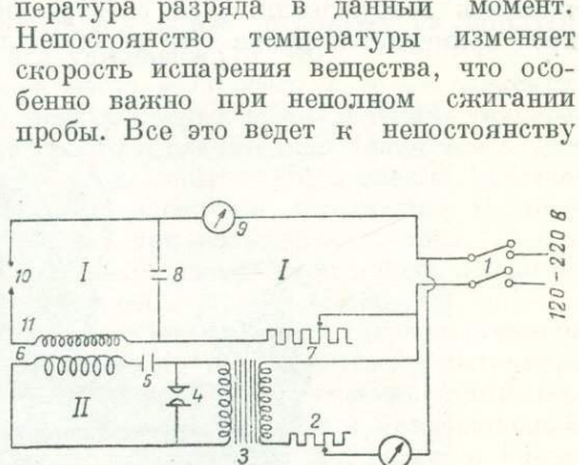
Фиг. 4. Схема генератора дуги переменного тока.
