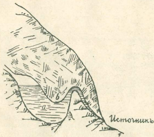
Черт. 29. Перемежающійся источникъ, функционированіе котораго находится въ зависимости отъ уровня воды въ пещерѣ a .
