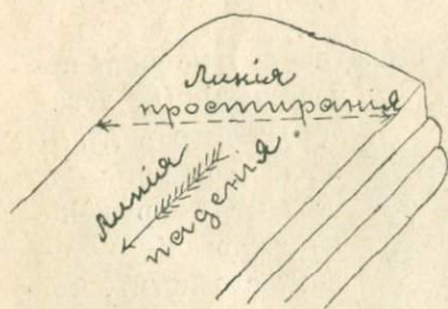
Черт. 13. Линія простиранія пласта, т. е. линія пересѣченія одного изъ боковъ (висячаго или лежачаго) пласта съ горизонтальною плоскостью, проведенною въ данномъ мѣстѣ пласта.
