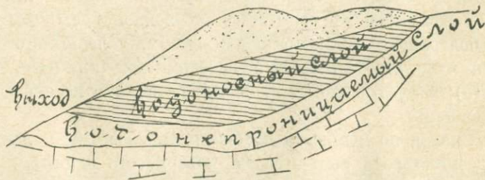
Черт. 25. Выходъ нисходящаго источника по уклону водопроницаемаго слоя.
