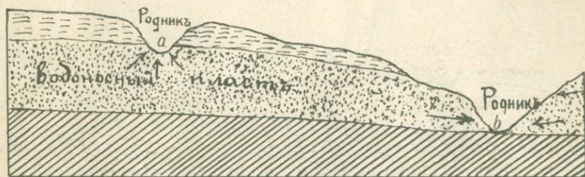
Черт. 48. Источники верхней и нижней воды одного и того-же водоноснаго слоя: a —родникъ верхней воды, b —родникъ нижней воды.
