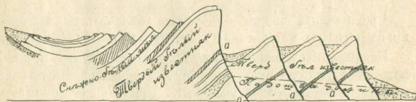
Черт. 6. Сложный сбросъ. Свита пластовъ разбита на части нѣсколькими сбросами. По выходамъ породъ (обнаженіямъ) возможно составить неправильное представленіе о характерѣ напластованій: повторяющаяся четыре раза одна и та же порода a можетъ быть ошибочно принята за различные послѣдовательныя напластованія, лежація другъ на другѣ на значительномъ протяженіи.
