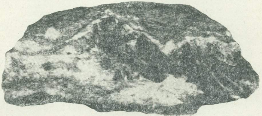
Рис. 15. Структура будинаж в пегматитовых телах. Отчетливо видно дробление и растаскивание отдельных частей кристаллов турмалина (черное), лейкократовый материал плавно огибает будины.
