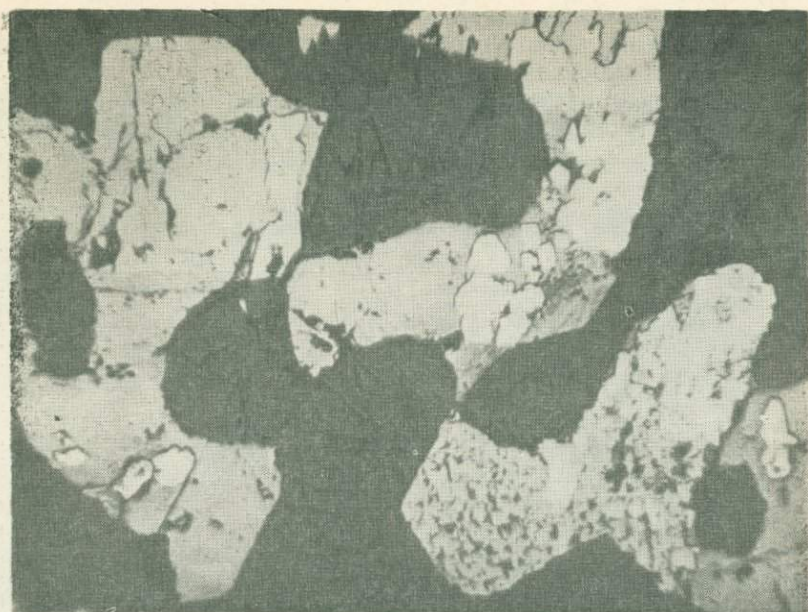
Рис. 3. Пирит (белый — рельефный среди пирротина в виде остатков). Микрофото, аншлиф, \times 100 .
