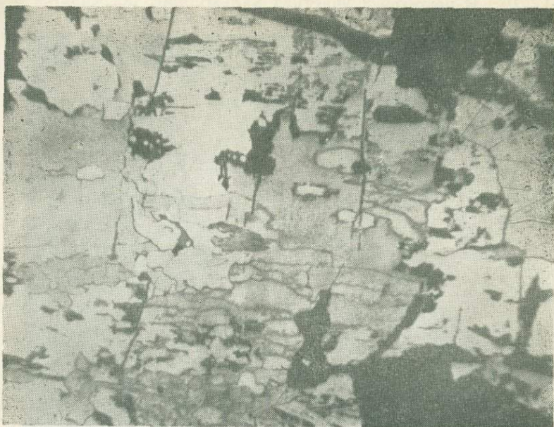
Рис. 6. Халькопирит замещает пирит (рельефный). Микрофото, аншлиф, \times 100 .
