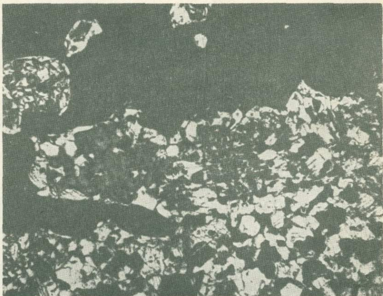
Рис. 2. Руда магнетитовая в контакте с оливин-гиперстеновой породой, без анализатора, диаметр поля зрения 4,7 мм.
