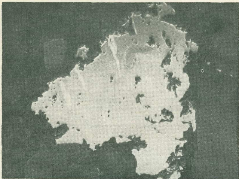
Рис. 1. Пентландит в виде мелких выделений (белые) в пирротине (немного темнее пентландита). Микрофото, аншлиф, \times 100 .
