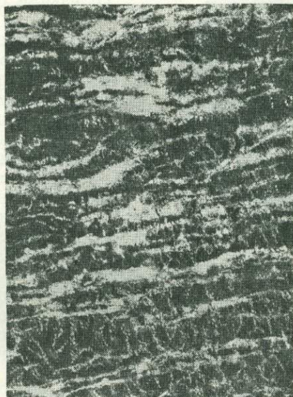
Рис. 7. Полосчатая руда. Бедная апатитом разность. Кукиевумчорр. \times 0,5 .
