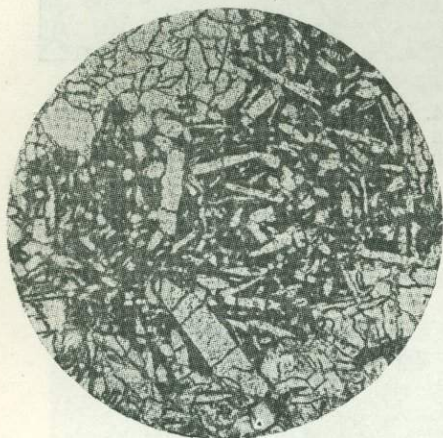
Рис. 6. Пятно с неориентированным распределением кристаллов апатита. Цементирует эгириин-авгит. Структура пойкилитовая. Никולי ||. \times 16 .
