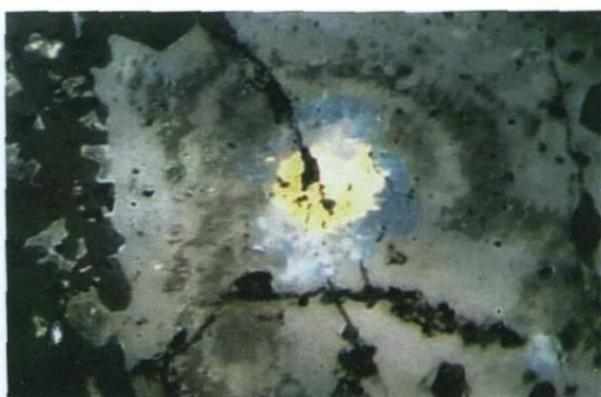
Рис. 3.33. Воскесар. Концентрическая структура замещения халькопирита (желтое) с гидроокислами железа (серое), халькоzinом (белое), ковеллином (голубое) и борнитом (розовое). Аншлиф Ерк-к-2.2/1, ув. X400, Dijital 000045, к.17.
